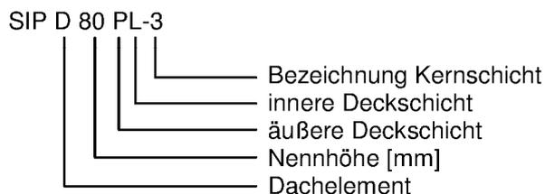
Sandwichelemente "SIP W" und SIP D" nach EN 14509 mit Stahldeckschichten und einem Kernwerkstoff aus Polyurethan-Hartschaum
