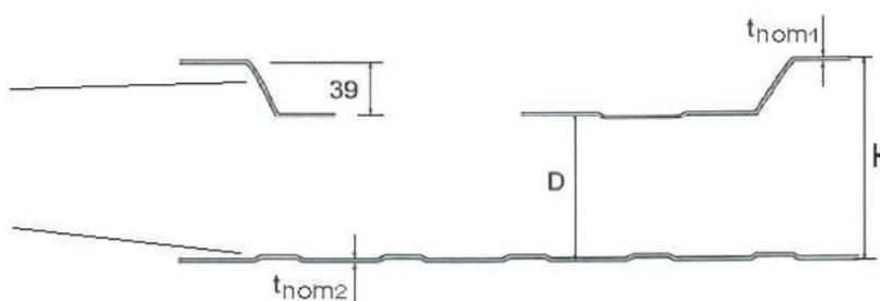
$t_{nom}$  : Nennblechdicken der Deckschichten
