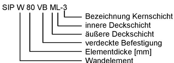
Sandwichelemente "SIP W" und SIP D" nach EN 14509 mit Stahldeckschichten und einem Kernwerkstoff aus Polyurethan-Hartschaum
