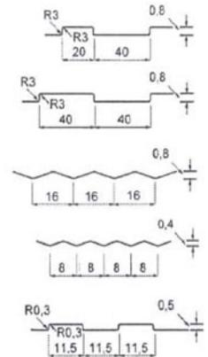
**t<sub>nom1</sub> = 0,50/0,60/0,75 mm:** Nennblechdicken der äußeren Deckschichten
