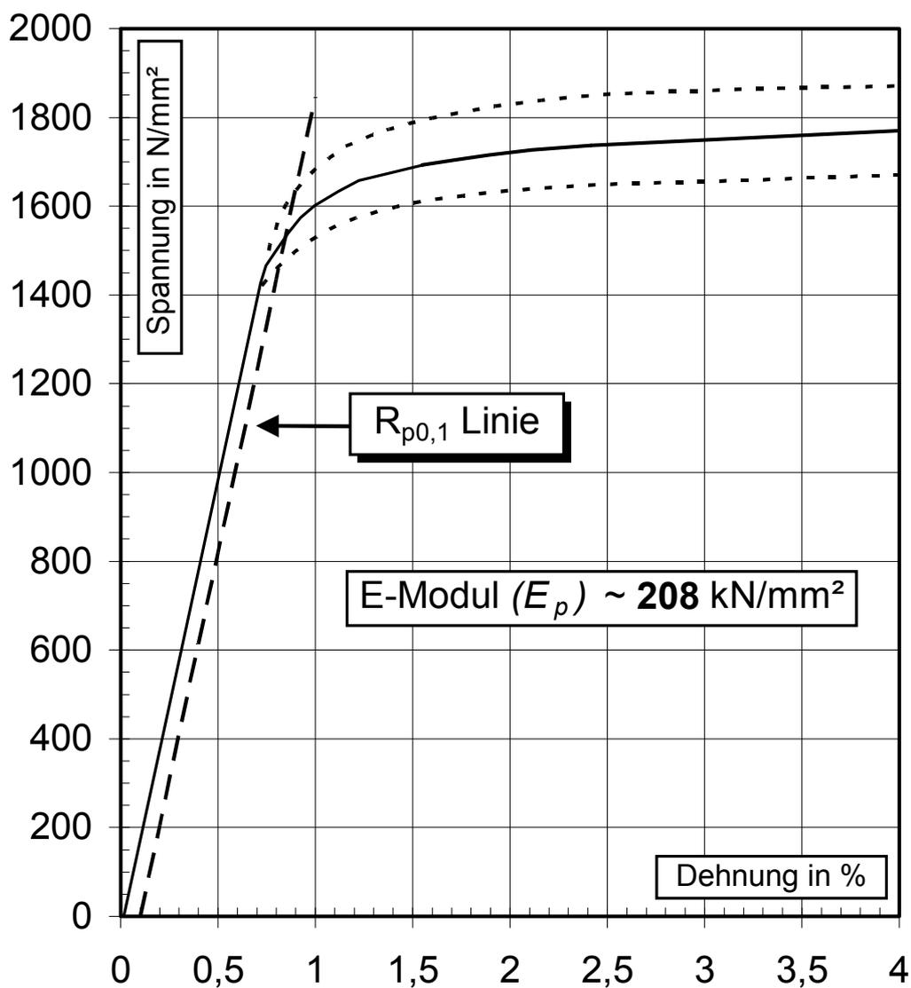
Die gestrichelten Linien markieren etwa den Bereich, innerhalb dessen die tatsächlichen Spannungs-Dehnungslinien auftreten können.
