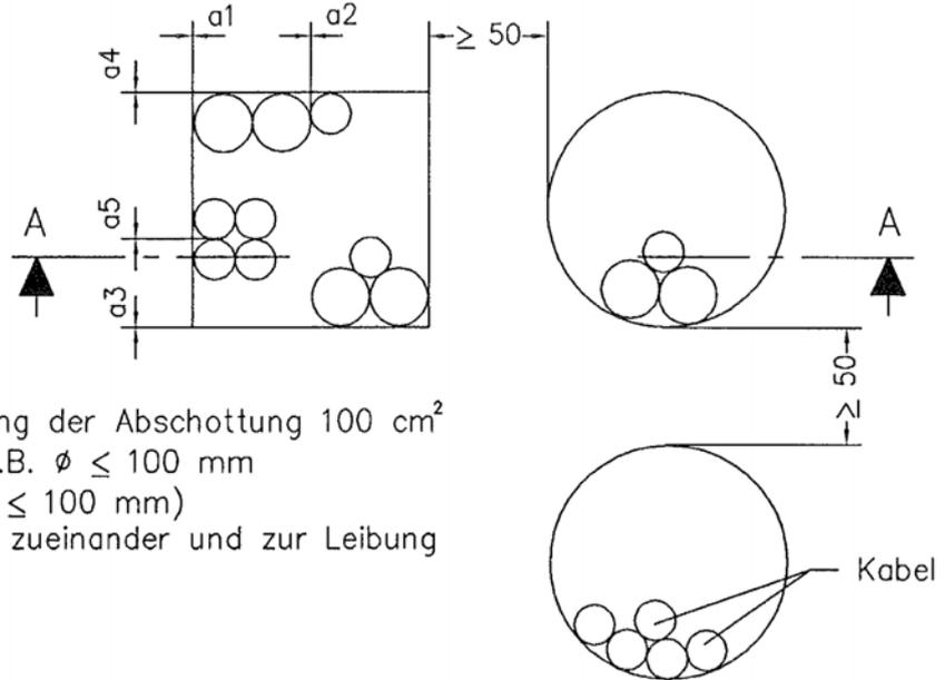
Maximale Abmessung der Abschottung 100 cm<sup>2</sup>
