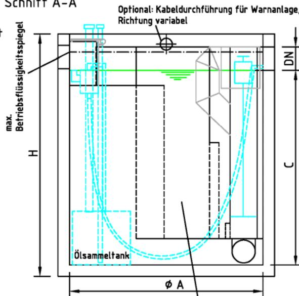
Abscheider Klasse I: hydraulische Koaleszenzwirkung erzeugt durch Lochblech mit Lochdurchmesser 15 mm
