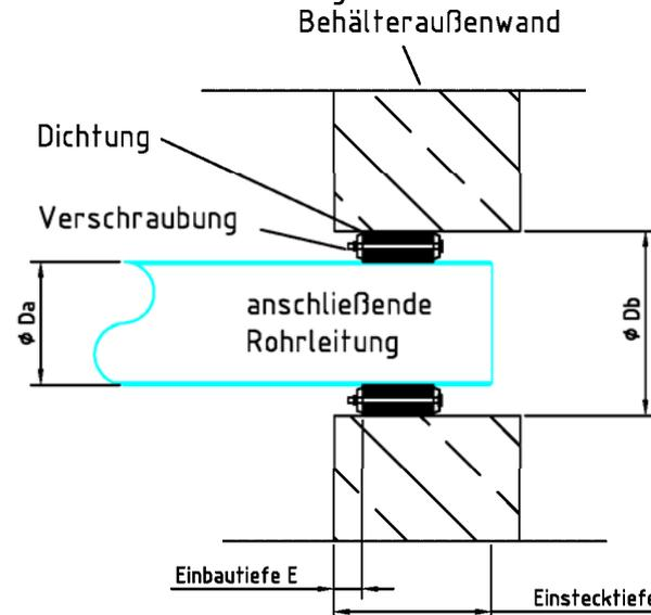
Rohrdurchführungen, Anschluss für Steinzeug Dichtelement BKK.
