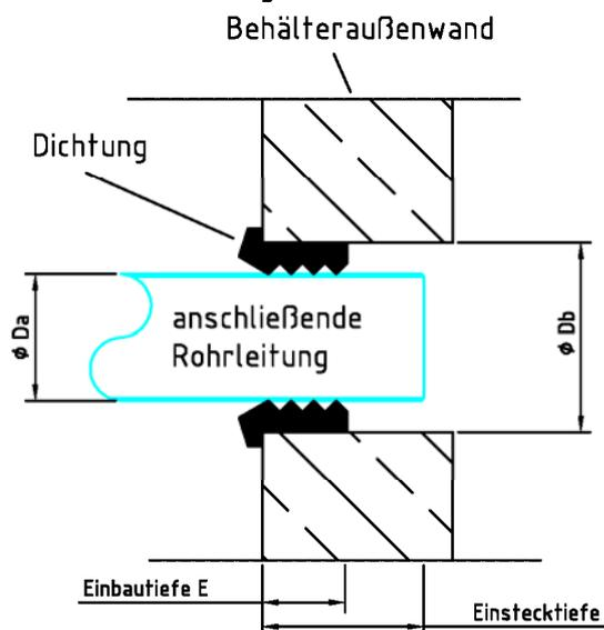
Rohrdurchführungen, Anschluss für Ringraumdichtung.
