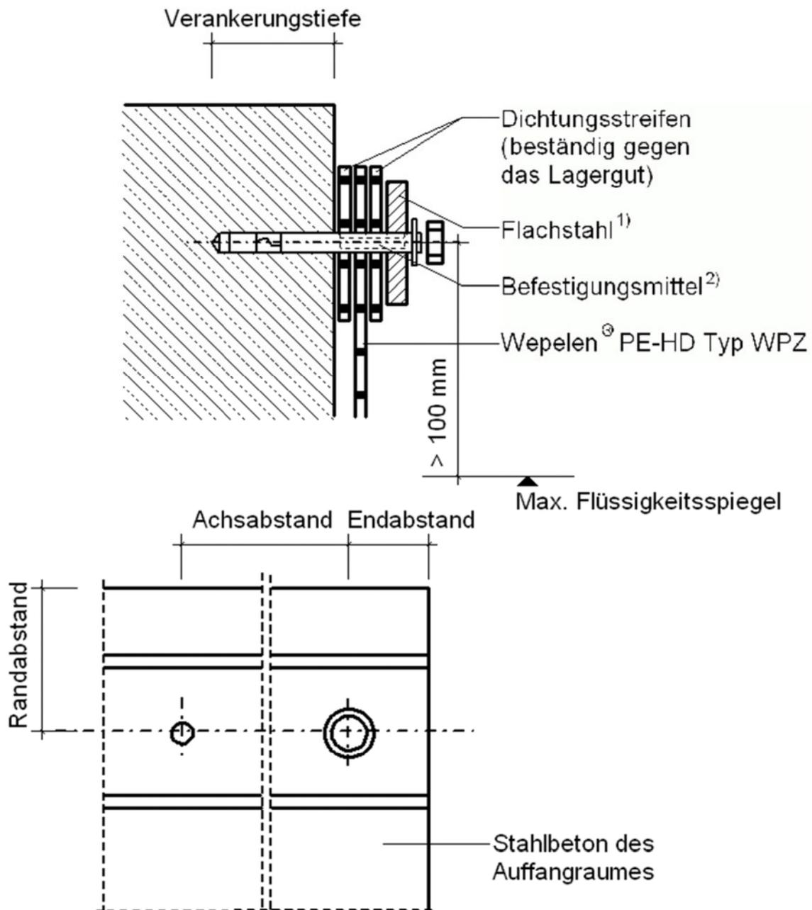
1) Flachstahl 6mmx60mm alternativ 8mmx40mm aus nichtrostendem Stahl unter Beachtung der Korrosionswiderstandsklassen nach allgemeiner bauaufsichtlicher Zulassung Z-30.3-6
