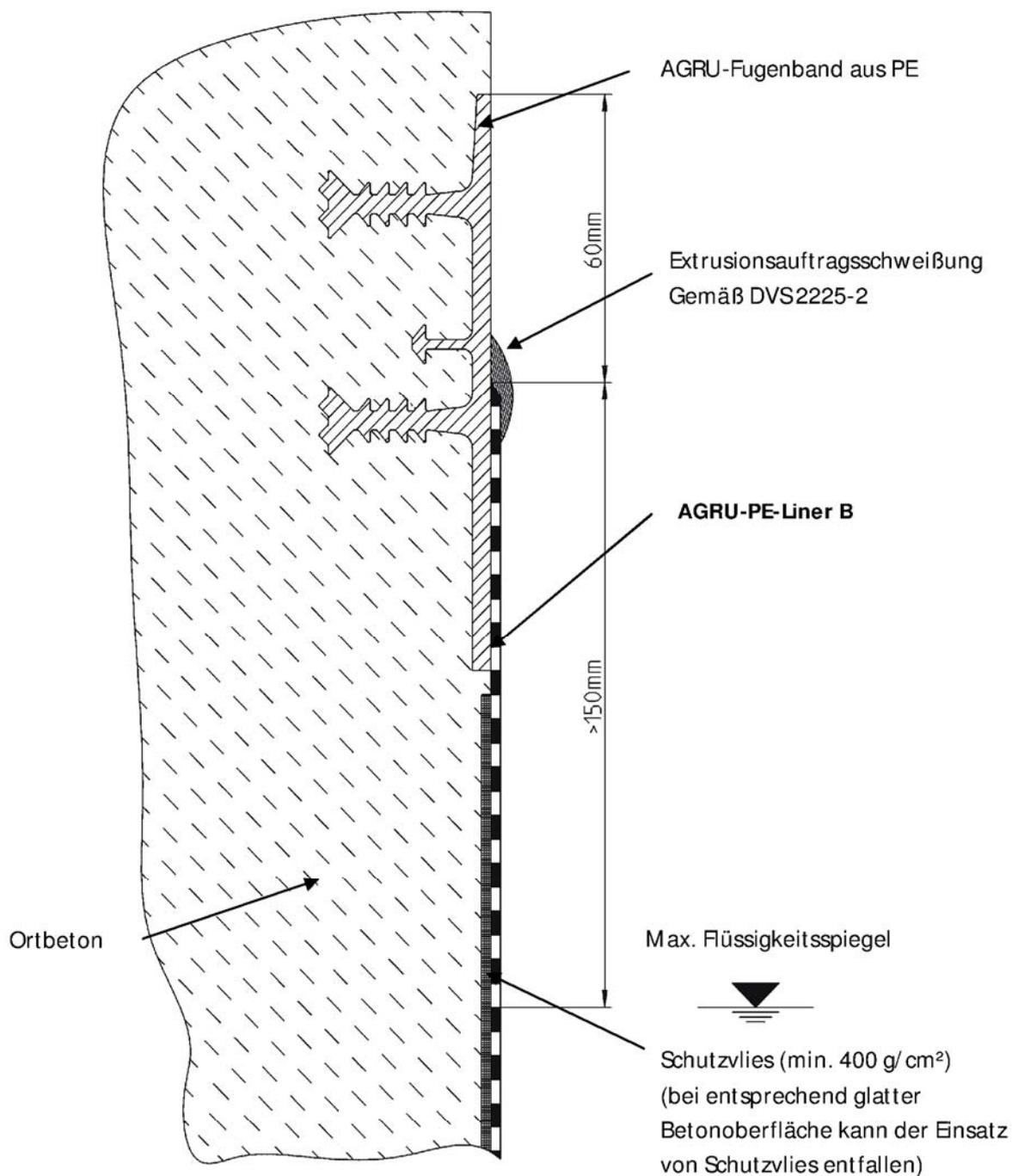
Dichtungsbahn "AGRU-PE-Liner B" als Abdichtungsmittel von Auffangwannen und -
