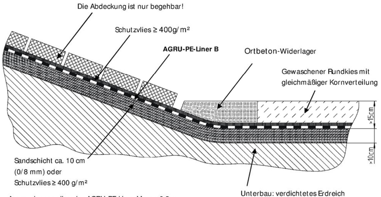
Ausrundungsradien der AGRU-PE-Liner M:  $r > 0,3$  m
