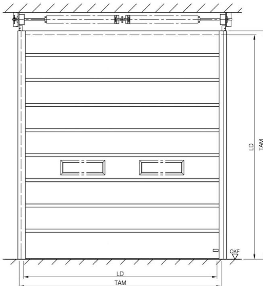
**T 30-1-RS-FSA „Teckentrup S“ immer mit unterer Bodendichtung ausführen Wandanschlüsse mindesten einseitig dauerelastisch versiegeln!**
