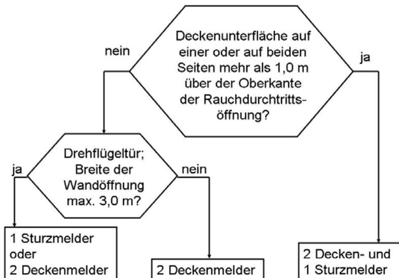
Bild 3: Entscheidungsdiagramm
