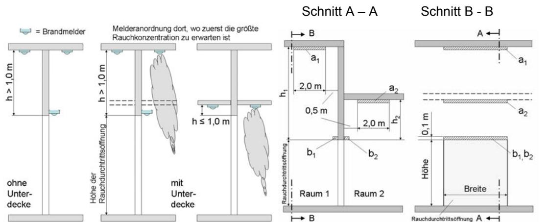
Bild 1: Maßgebende Höhe der Deckenunterfläche
