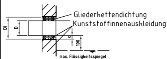
Detail "C": Rohrdurchführung
