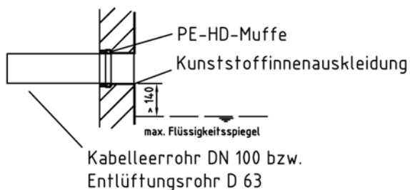
Detail: Durchführung Kabelleerrohr / Entlüftung
