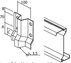
Befestigung des Pfettenstuhles über Grundplatte auf der Unterkonstruktion
