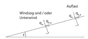
Beanspruchung der Verbindung Stahltrapezprofiltafel - Pfette
