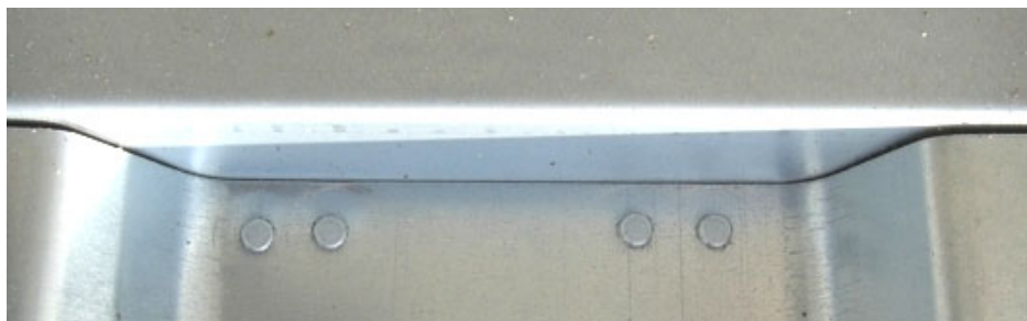
Beispiel für eine durch Clinchen hergestellte Verbindung
