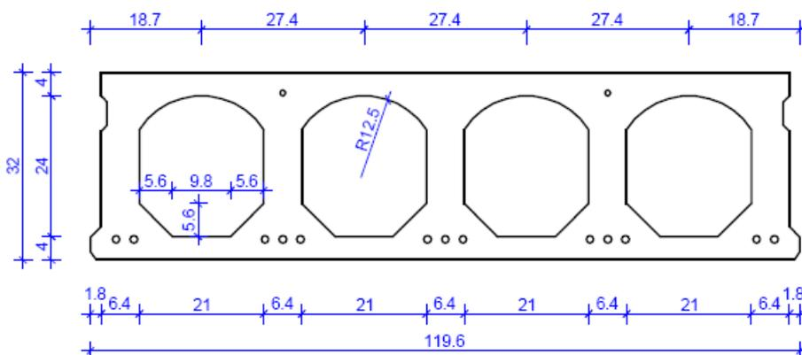
Verwendung von Spannbeton-Hohlplatten nach DIN EN 1168:2011-12
