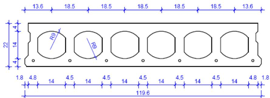
Verwendung von Spannbeton-Hohlplatten nach DIN EN 1168:2011-12
