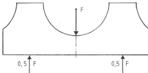
**Bild 1:** Belastungsanordnung Biegeversuch
