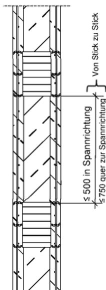
Halbfertigwand mit KAPPEMA-Bewehrungselementen aus Stahl als Verbindungselement
