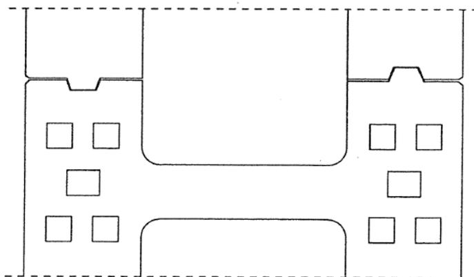
Mauerwerk aus Schallschutz-Planziegeln SZ 4109
