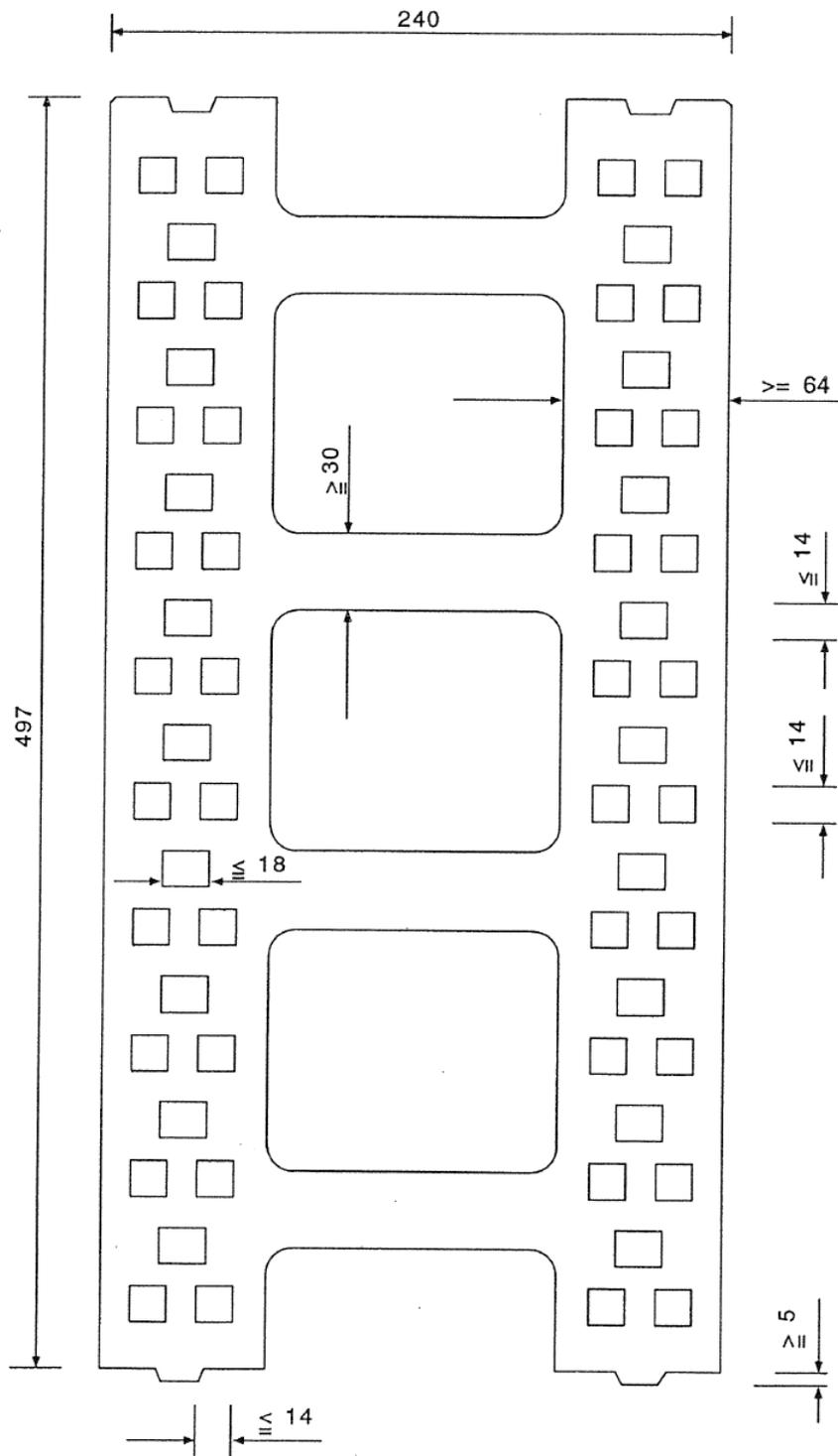
Mauerwerk aus Schallschutz-Planziegeln SZ 4109
