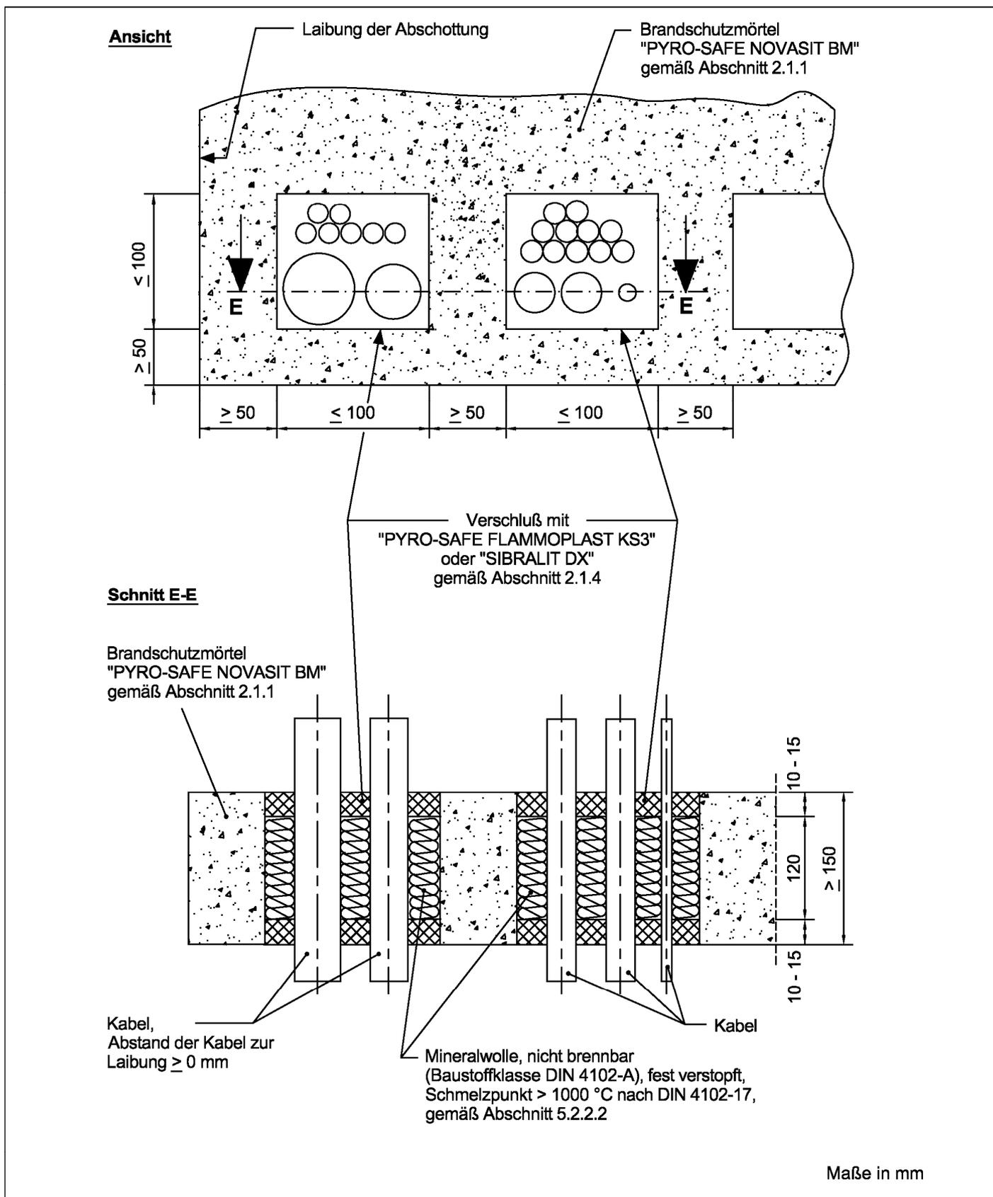
Kabelabschottung (Kombiabschottung) "PYRO-SAFE Novasit COMBI 90" der Feuerwiderstandsklasse S 90 nach DIN 4102-9
