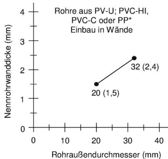
\* nach DIN 8062, DIN 6660, DIN19531, DIN 19532, DIN 8079
