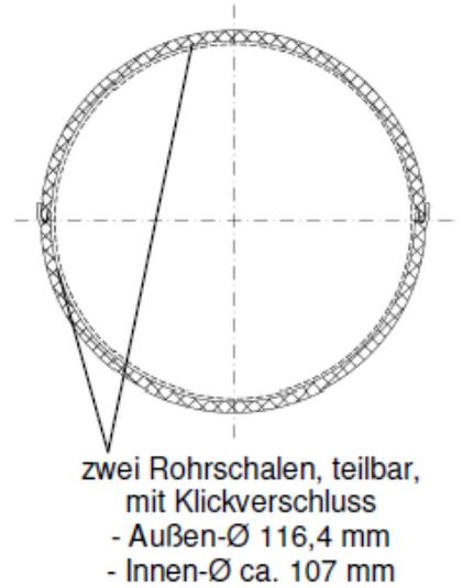
**Cable-Tubes „PYRO-SAFE CT“ bei Anordnung in Bauteilöffnungen von Massivwänden**
