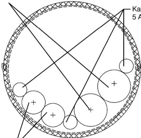
Kunststoffrohre\* mit Außen-Ø 20 mm x s 1,5 mm, bis zu 2 Stück
