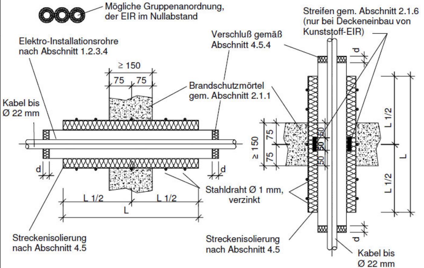
Einbau von starren und biegsamen Elektro-Installationsrohren (EIR) nach DIN EN 61386 bzw. DIN EN 50086 aus Kunststoff- oder Stahlqualitäten
