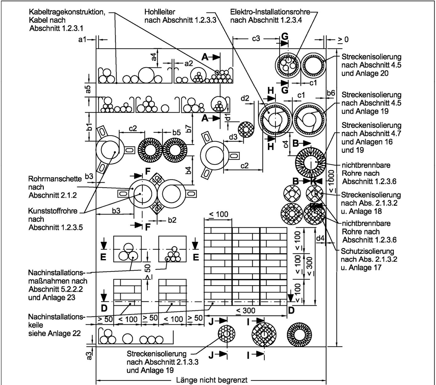
**Maximale Abmessungen der Abschottung:**
