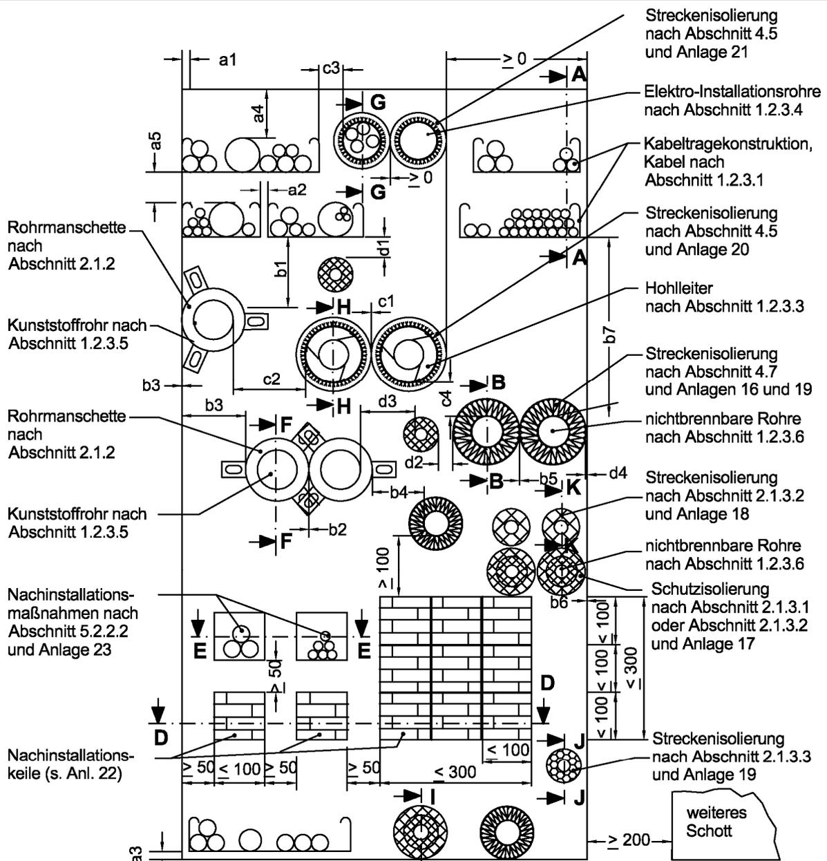
**Maximale Abmessungen der Abschottung:**
