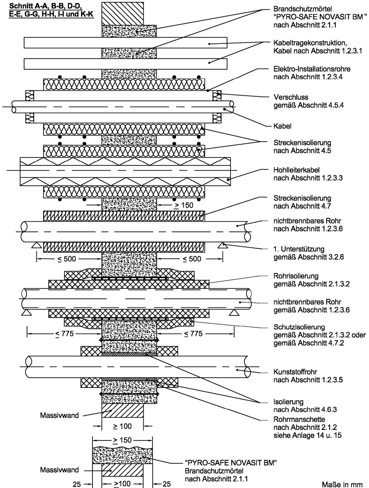
Kabelabschottung (Kombiabschottung) "PYRO-SAFE Novasit COMBI 90" der Feuerwiderstandsklasse S 90 nach DIN 4102-9
