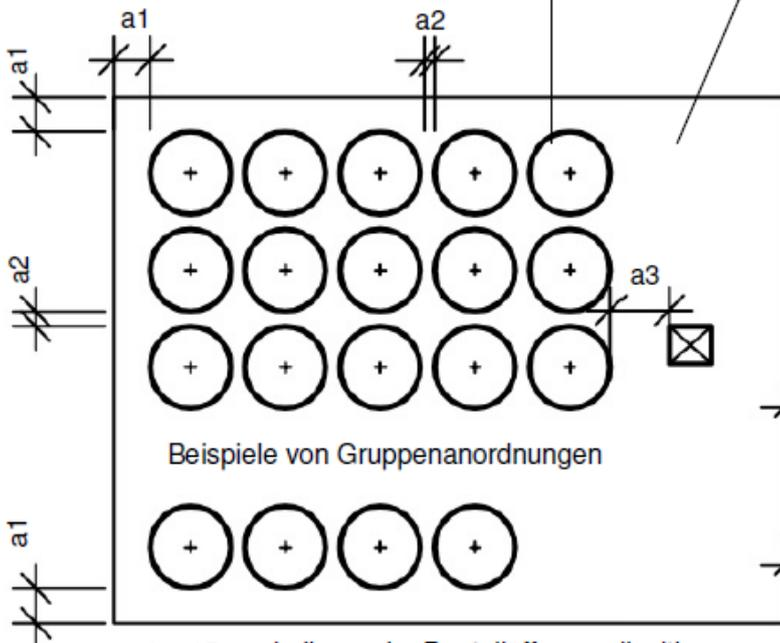
Maximale Abmessung der Abschottung
