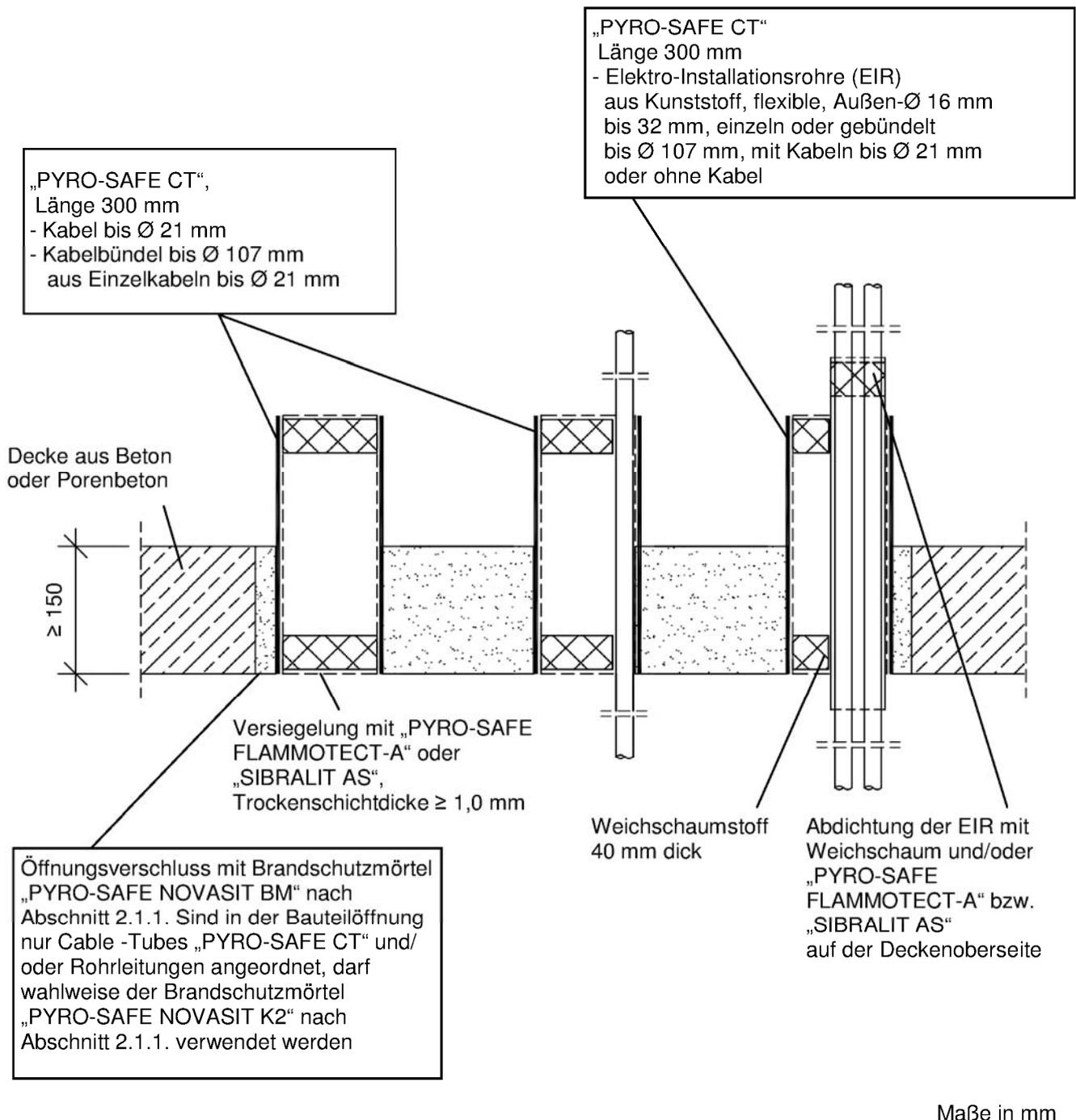
Kabelabschottung (Kombiabschottung) "PYRO-SAFE Novasit COMBI 90"
