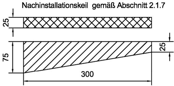
Bei Nachinstallationsmaßnahmen  $\geq 100 \text{ mm} \times 100 \text{ mm}$  sind die Keile in Paketen  $\leq 100 \text{ mm} \times 100 \text{ mm}$  zusammenzufassen
