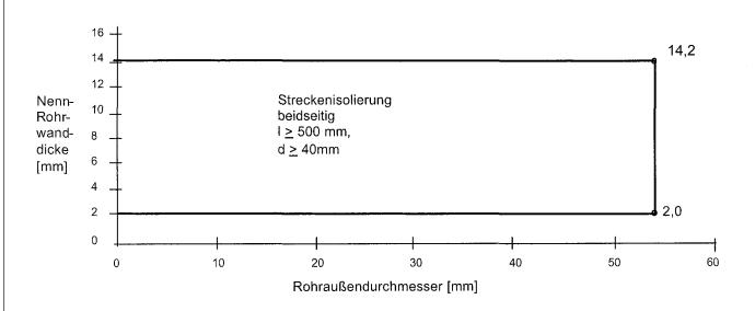
Kabelabschottung (Kombiabschottung) "System ISO-FLAME Stopfen und Platten S 90" der Feuerwiderstandsklasse S 90 nach DIN 4102-9
