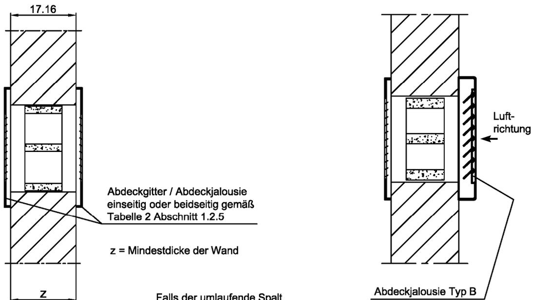
Falls der umlaufende Spalt größer als 2,5 mm ist, vollständig vermörteln oder mit Mineralwolle nach DIN 4102-A oder DIN EN 13501-1 ausstopfen.
