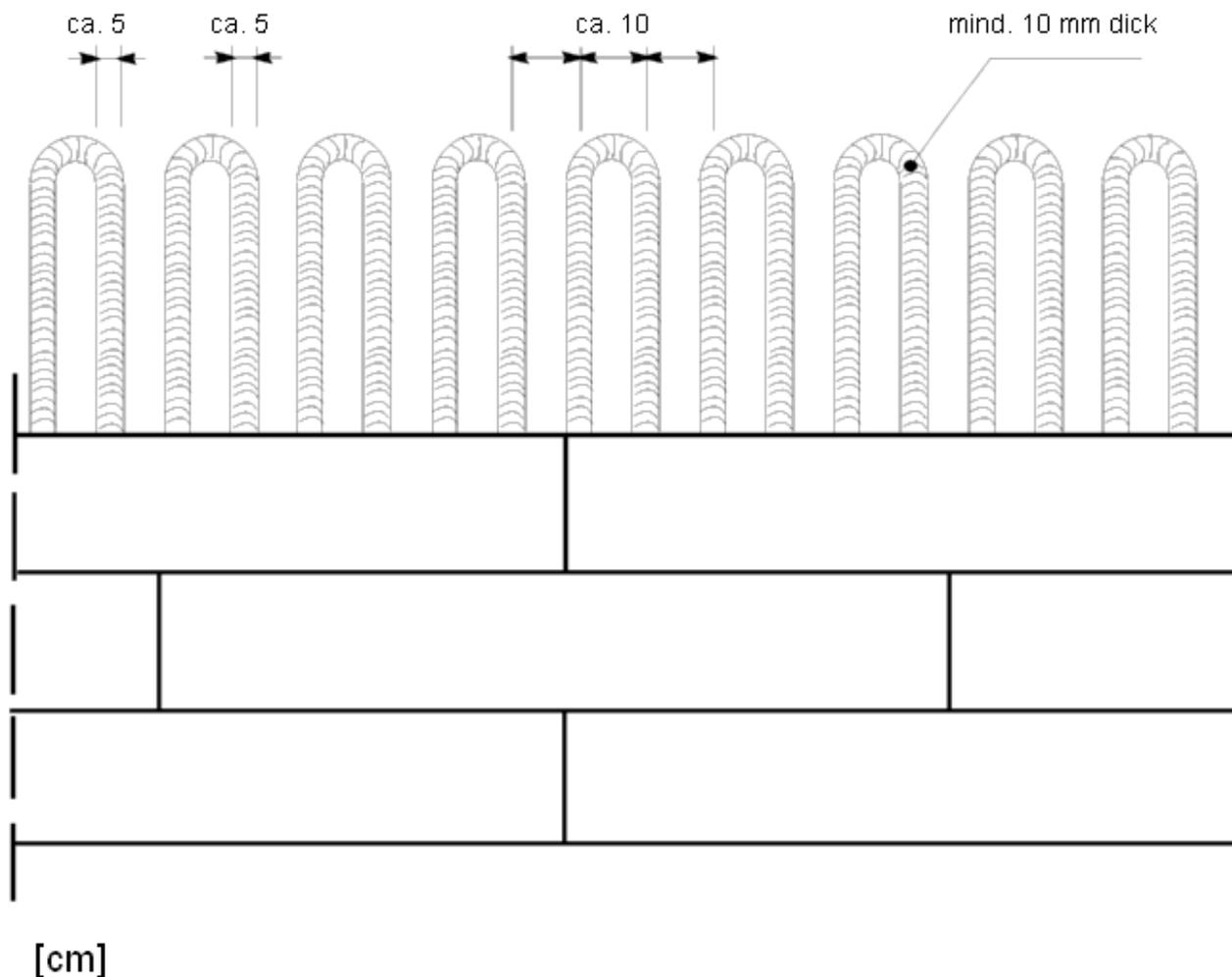
Wärmedämm-Verbundsystem mit angeklebten Mineralwolle- Lamellen Anlage 2.1
