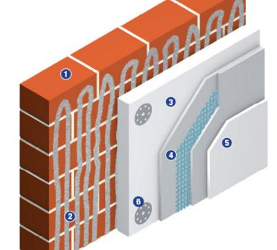
Mit Dübeln mechanisch befestigtes WDVS und zusätzlichem Klebemörtel
