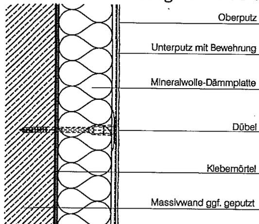
Mit Profilen mechanisch befestigtes WDVS und zusätzlichem Klebemörtel
