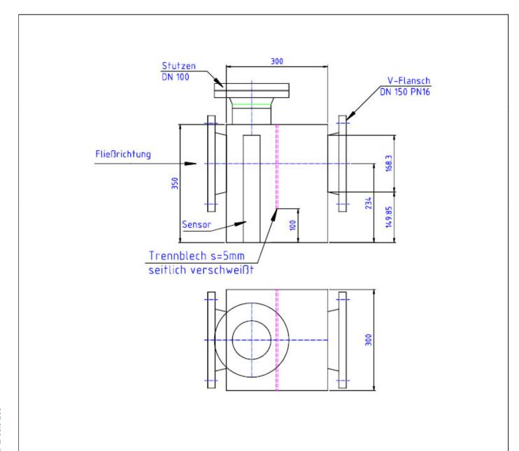
Drucklose Leckageüberwachung an senkrechten Gefäßwänden (LSG-K) eines Tankbauwerkes nach DIN 4119
