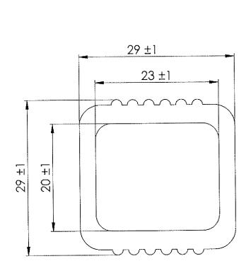
Materail: GFK oder Stahl PE ummantelt
