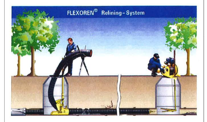
Sanierung erdverlegter Abwasserleitungen im Nennweitenbereich DN 125 bis DN 300 mit der Bezeichnung "Flexoren Kanalrohrsystem"
