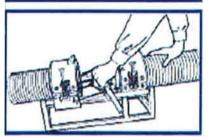
Halte- und Spannvorrichtung verschließen
