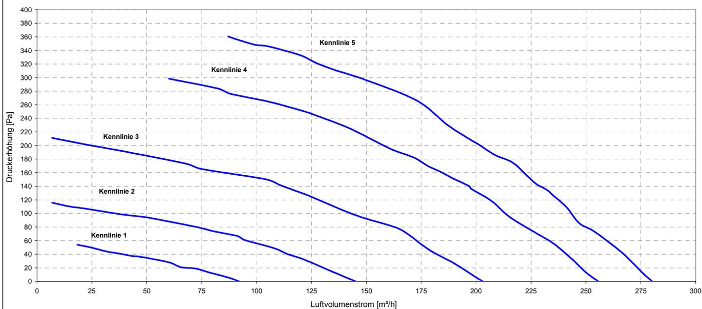
Zentrales Lüftungsgerät mit Wärmerückgewinnung - "WAC 200" mit vertikalen Kanalanschlüssen
