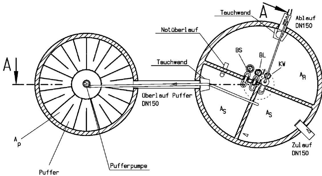
Alle Kammern können auch als separate, in unterschiedlicher Form und Größe, ausgebildete Behälter sein. Zu- und Abläufe der Nachrüstung sind der entsprechenden Ausführung anzupassen. Einzelne Kammern bzw. Behälter können, falls es sich aus der klärtechnischen Berechnung ergibt, stillgelegt werden.
