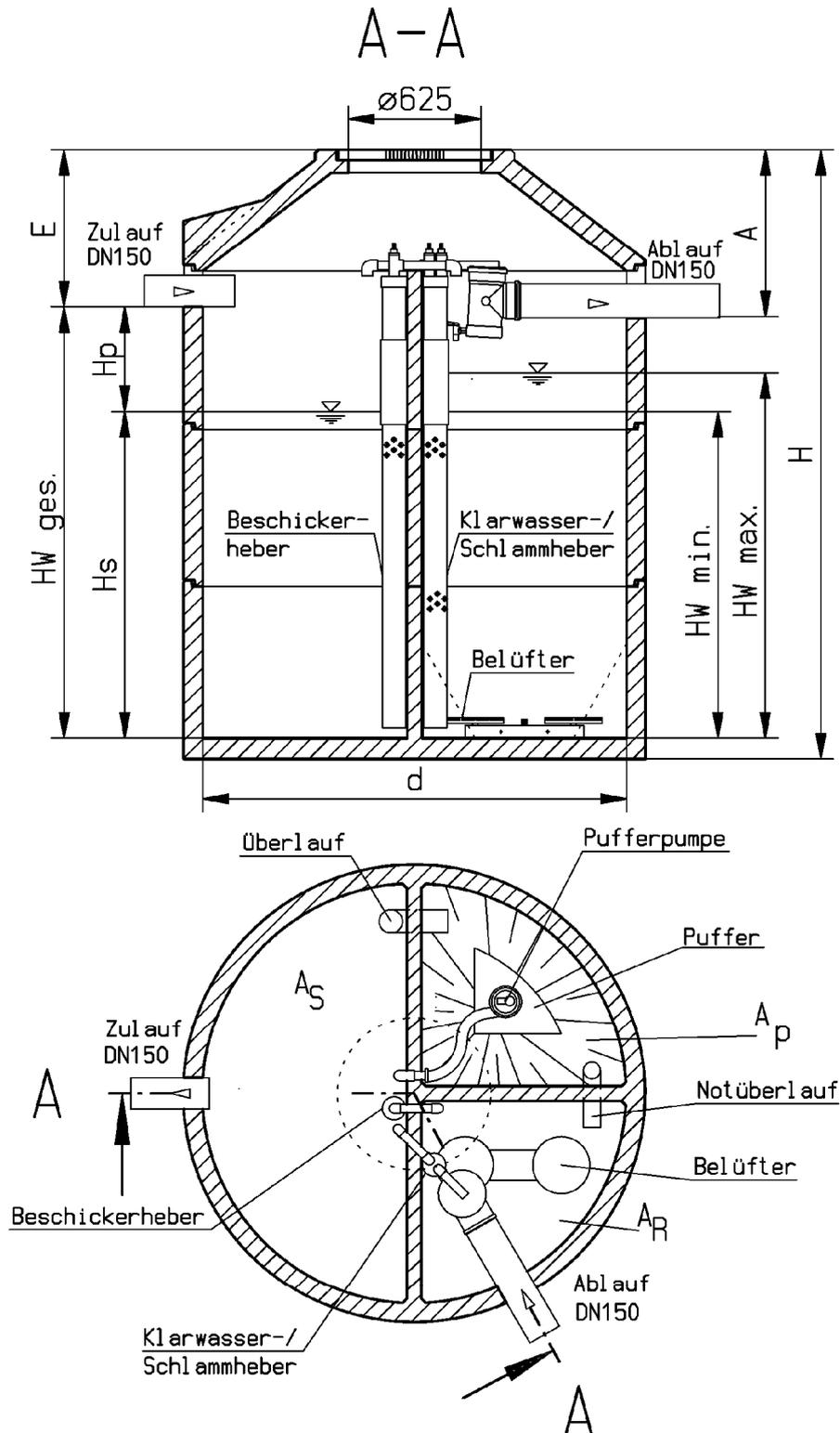
Alle Kammern können auch als separate, in unterschiedlicher Form und Größe, ausgebildete Behälter sein. Zu- und Abläufe der Nachrüstung sind der entsprechenden Ausführung anzupassen. Einzelne Kammern bzw. Behälter können, falls es sich aus der klärtechnischen Berechnung ergibt, stillgelegt werden.
