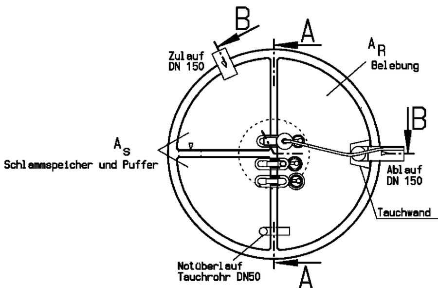
Kleinkläranlagen mit Abwasserbelüftung; Belüftungsanlagen im Aufstaubetrieb;
