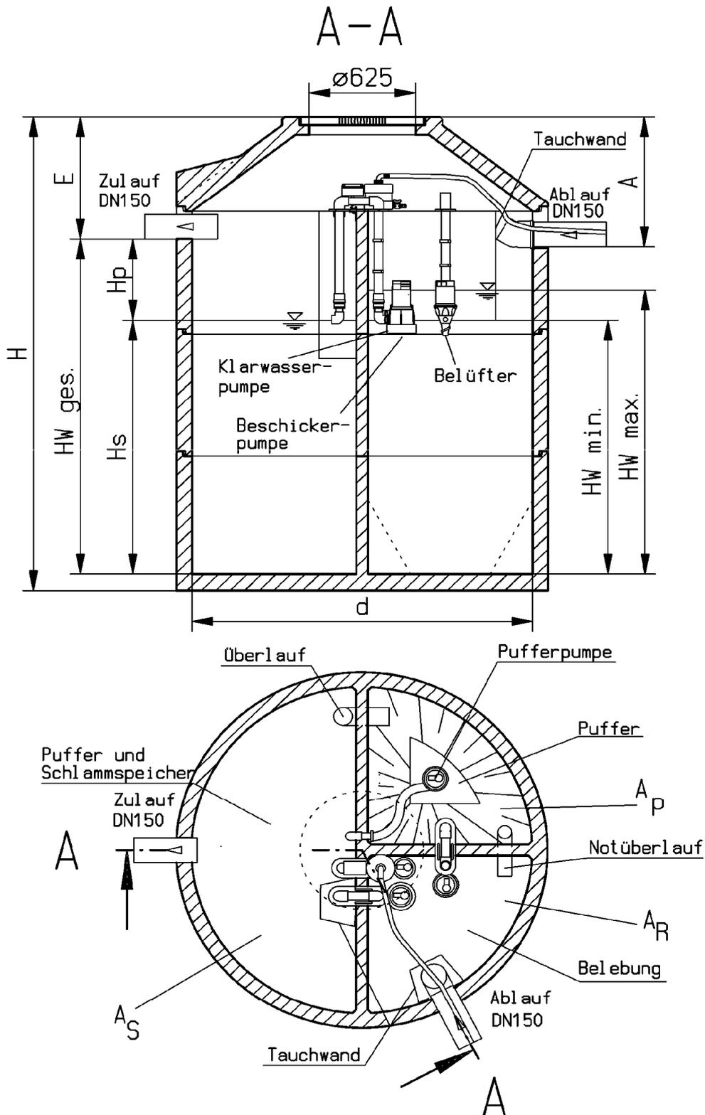
Alle Kammern können auch als separate, in unterschiedlicher Form und Größe, ausgebildete Behälter sein. Zu- und Abläufe der Nachrüstung sind der entsprechenden Ausführung anzupassen. Einzelne Kammern bzw. Behälter können, falls es sich aus der klärtechnischen Berechnung ergibt, stillgelegt werden.
