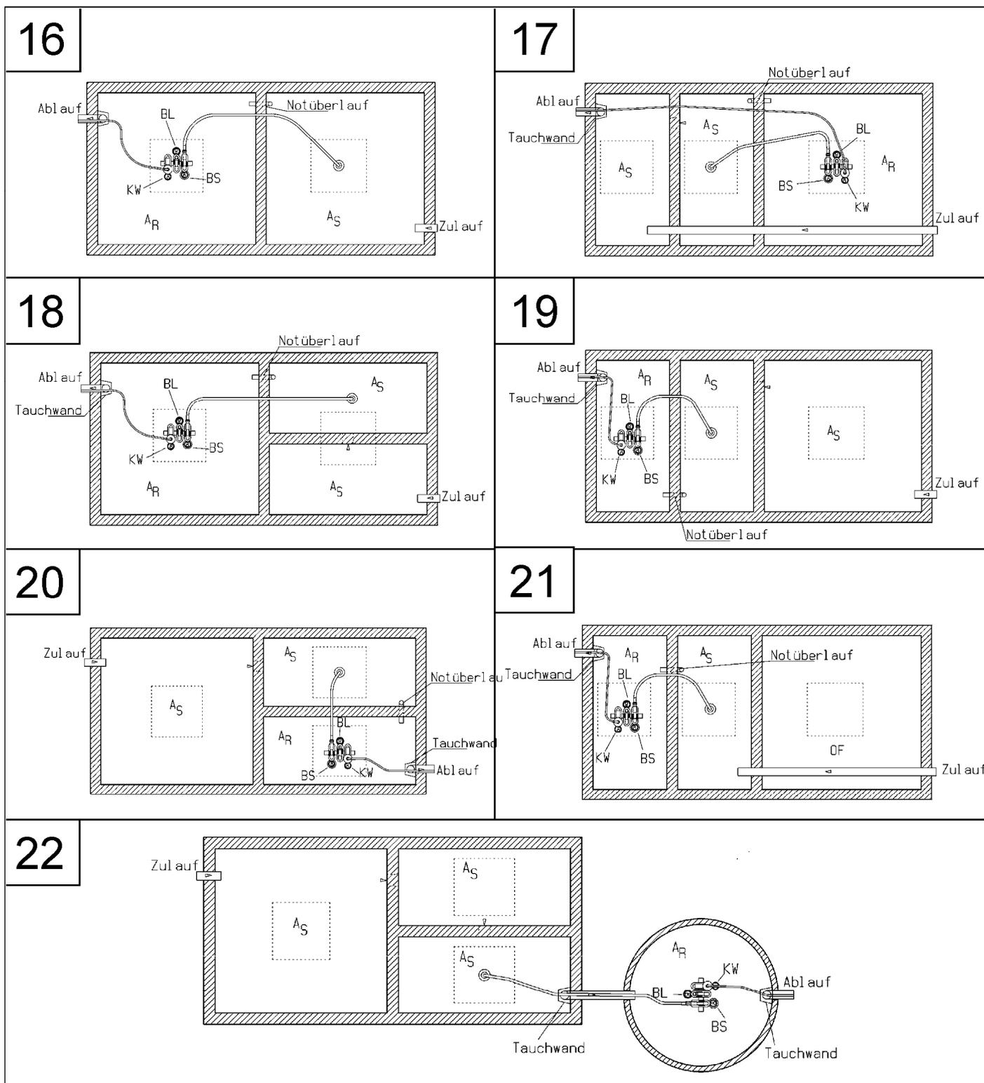
Abkürzungen: A<sub>S</sub> = Schlamm Speicher und Puffer, A<sub>R</sub> = Belebung, OF = Ohne Funktion, KW = Klarwasserpumpe, BS = Beschickerpumpe, BL = Belüfter
