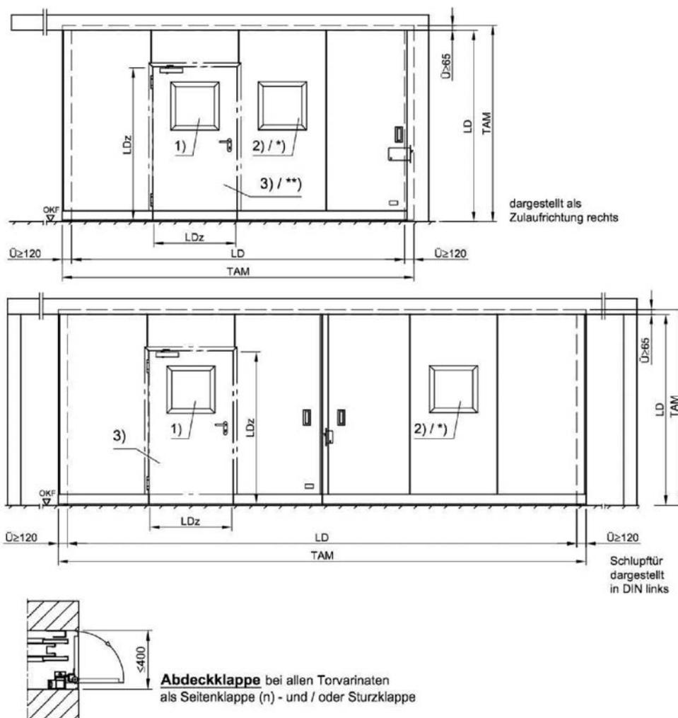
T 30-1-RS-FSA und T 30-2-RS-FSA „Teckentrup 72 E immer mit unterer Bodendichtung ausführen. Elementstöße und Wandanschlüsse mindesten einseitig dauerelastisch versiegeln!
