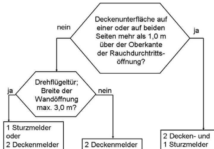
Bild 3: Entscheidungsdiagramm
