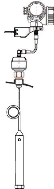
Schema der Überfüllsicherung
