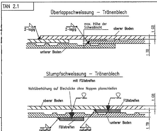
Leckschutzauskleidungen aus Stahl Typ TAN 1, TAN 2 und TAN 2.1 für Flachbodentanks nach DIN 4119
