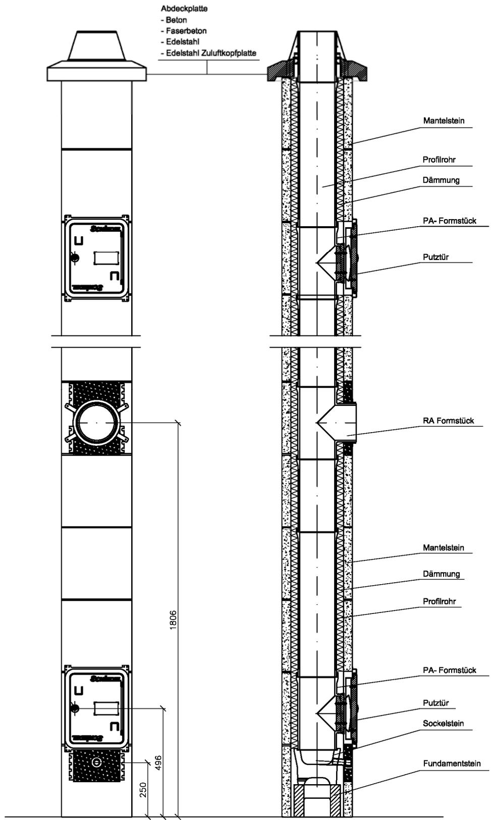
Bauarten für Bausätze aus Einzelteilen und zur werkmäßigen Vorfertigung von bewehrten Fertigteile-Abschnitten für Abgasanlagen
