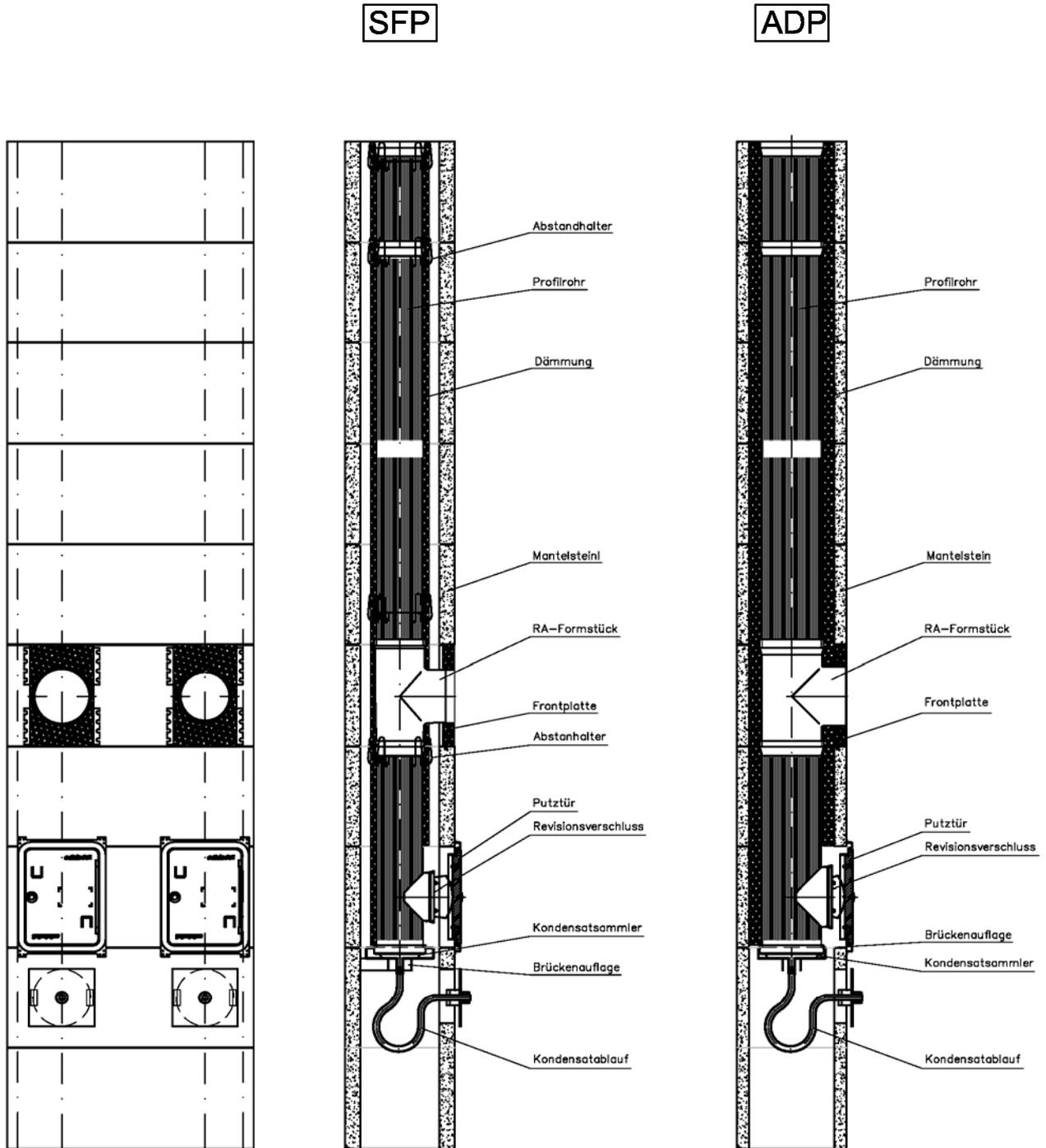
Bauarten für Bausätze aus Einzelteilen und zur werkmäßigen Vorfertigung von bewehrten Fertigteile-Abschnitten für Abgasanlagen
