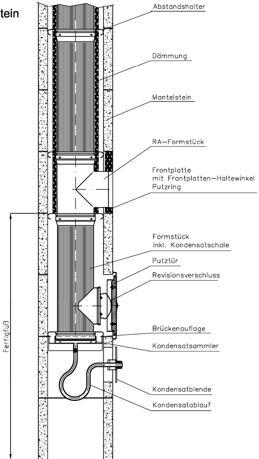
Bauarten für Bausätze aus Einzelteilen und zur werkmäßigen Vorfertigung von bewehrten Fertigteile-Abschnitten für Abgasanlagen
