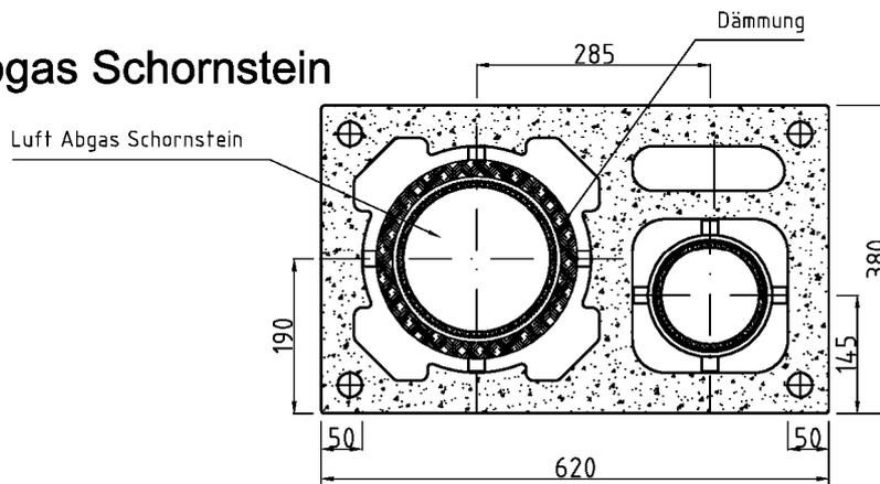
Bauarten für Bausätze aus Einzelteilen und zur werkmäßigen Vorfertigung von bewehrten Fertigteile-Abschnitten für Abgasanlagen
