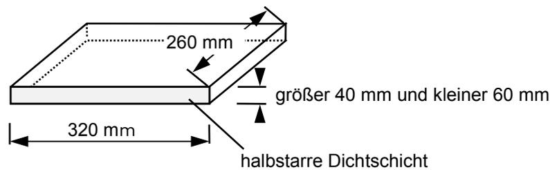
**Bohrkerne für die Eindringprüfung**
