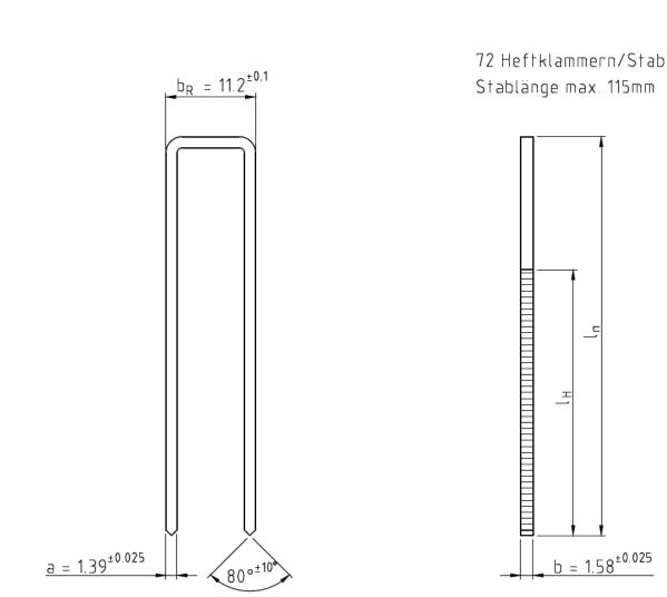
Rohdraht: Stahldraht  $\emptyset$ 1,52 $\pm$  0,01 aus Werkstoff 1.4301 (X 5 Cr Ni 18 10 = V2a) nach DIN EN 10088-1 mit einer Mindestfestigkeit von 950 N/mm<sup>2</sup>
