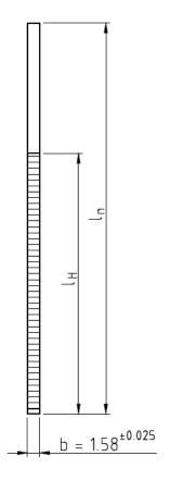
Rohdraht: Stahldrahtø 1,52 $\pm$ 0,01 aus Werkstoff 1.0413/1.0414 (D 15–2 /D 20–2) nach BIN EN 10016–2 mit einer Mindestfestigkeit von 900 N/mm²
