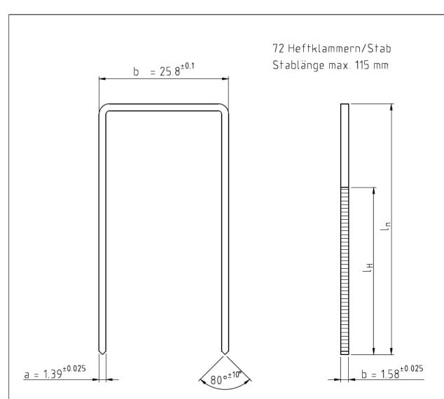
Rohdraht: Stahldraht ø1,52  $\pm$  0,01 aus Werkstoff 1.4301 (X 5 Cr Ni 18 10 = V2a) nach DIN EN 10088-1 mit einer Mindestfestigkeit von 950 N/mm<sup>2</sup>
