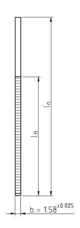
Rohstahl: Stahldraht  $\phi$ 1.52±0.01 aus Werkstoff 1.0413/1.0414 (D 15-2/ D20-2) nach DIN EN 10016-2 mit einer Mindestfestigkeit von 900 N/mm<sup>2</sup>
