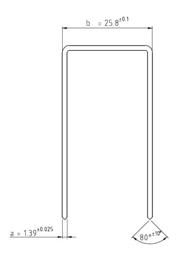
72 Heftklammern/Stab Stablänge max. 115 mm
