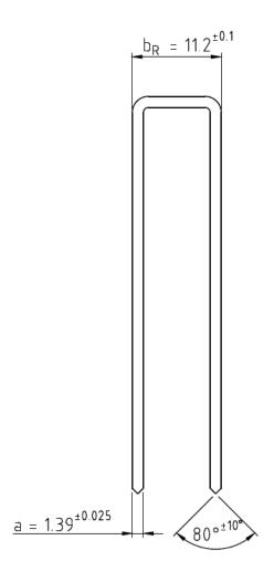
72 Heftklammern/Stab Stablänge max. 115mm
