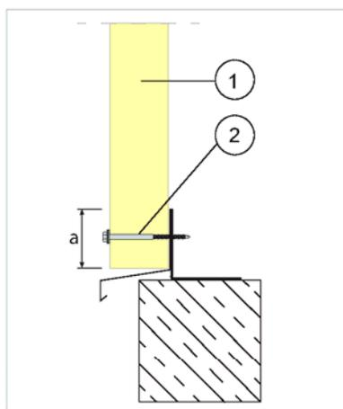
Bild 5: Fußpunkt Wandpaneel - aufgesetzt
