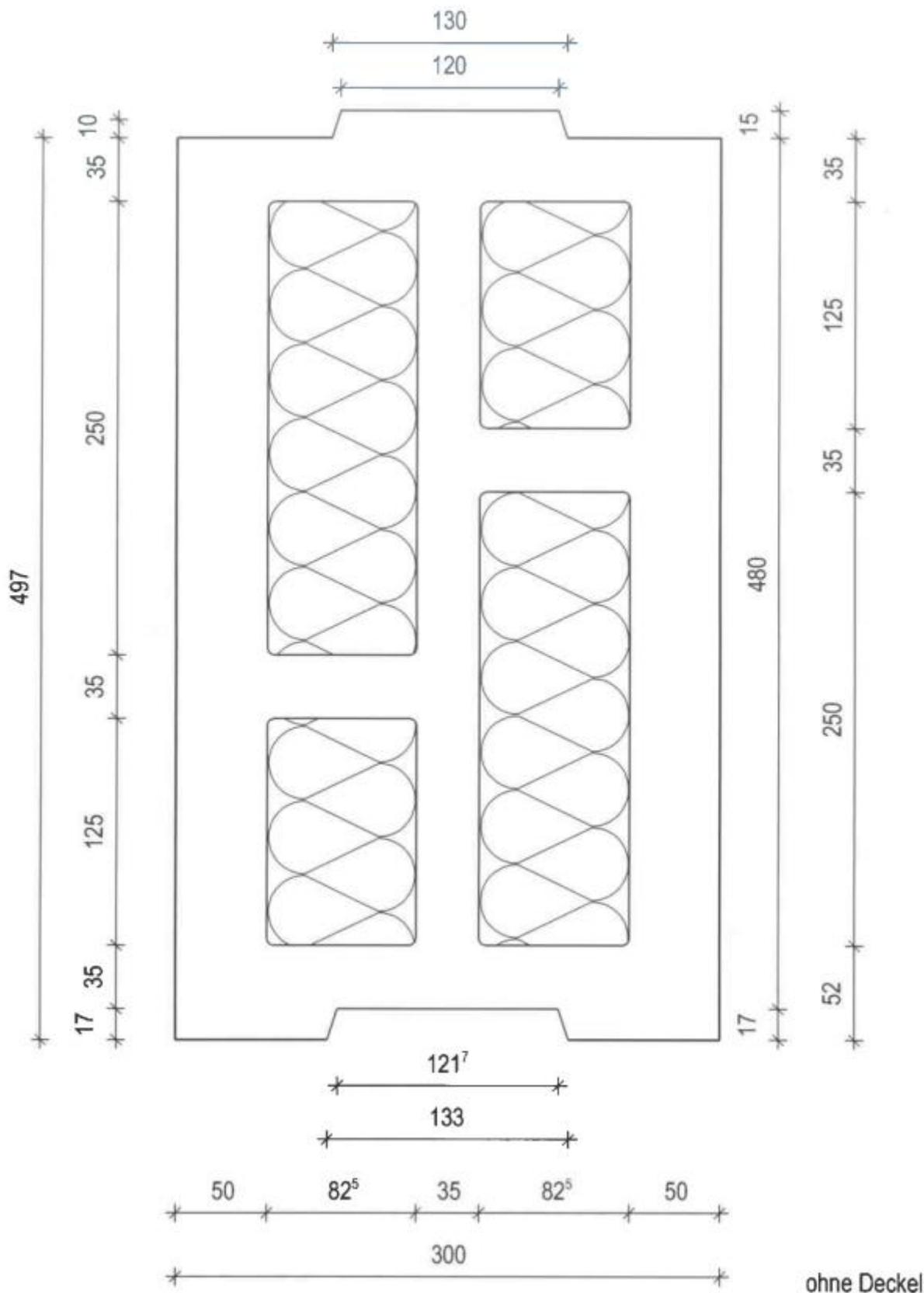
Mauerwerk aus BISOTHERM-Steinen mit integrierter Wärmedämmung
