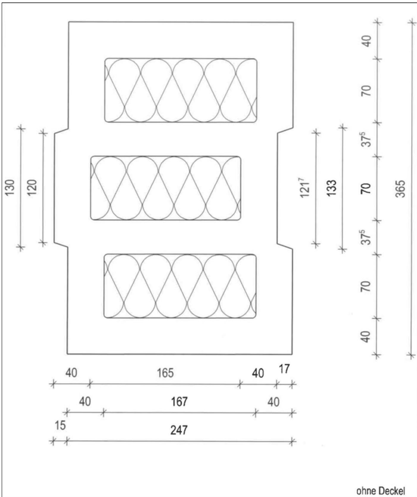
Mauerwerk aus BISOTHERM-Steinen mit integrierter Wärmedämmung
