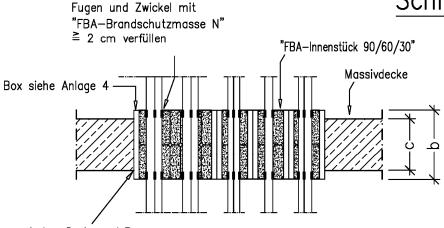
Fuge zwischen Decke und Box von der Deckenunterseite her mit mineralischem Mörtel, Gips oder "FBA-Brandschutzmasse N"in einer Tiefe ≧ 2 cm verschließen
