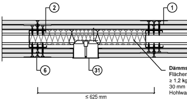
**Dämmstoff, Schmelzpunkt  $\geq 1000$  °C**
