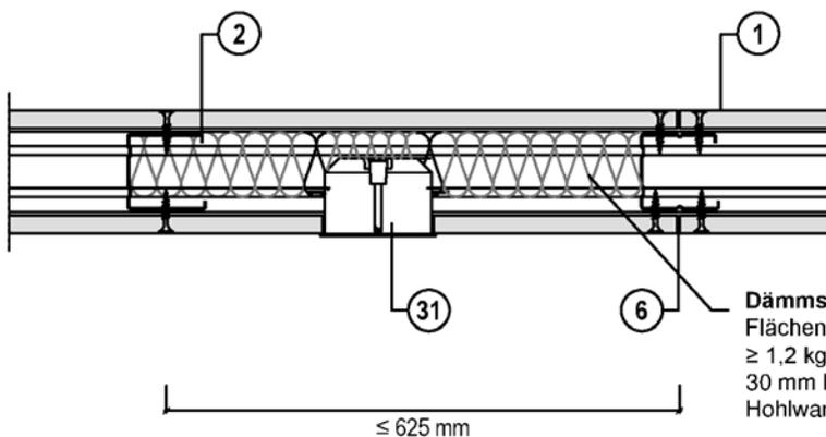
**Dämmstoff, Schmelzpunkt  $\geq 1000\text{ °C}$**
