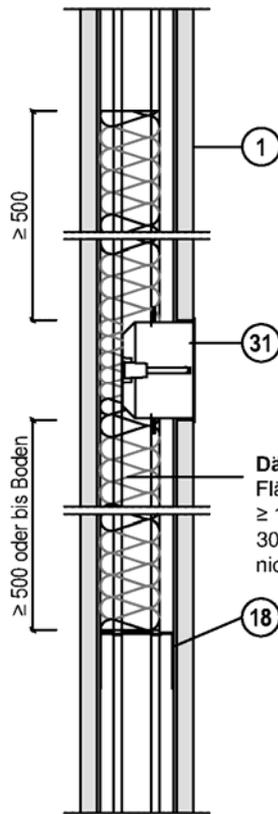
**Dämmstoff, Schmelzpunkt  $\geq 1000\text{ °C}$**
