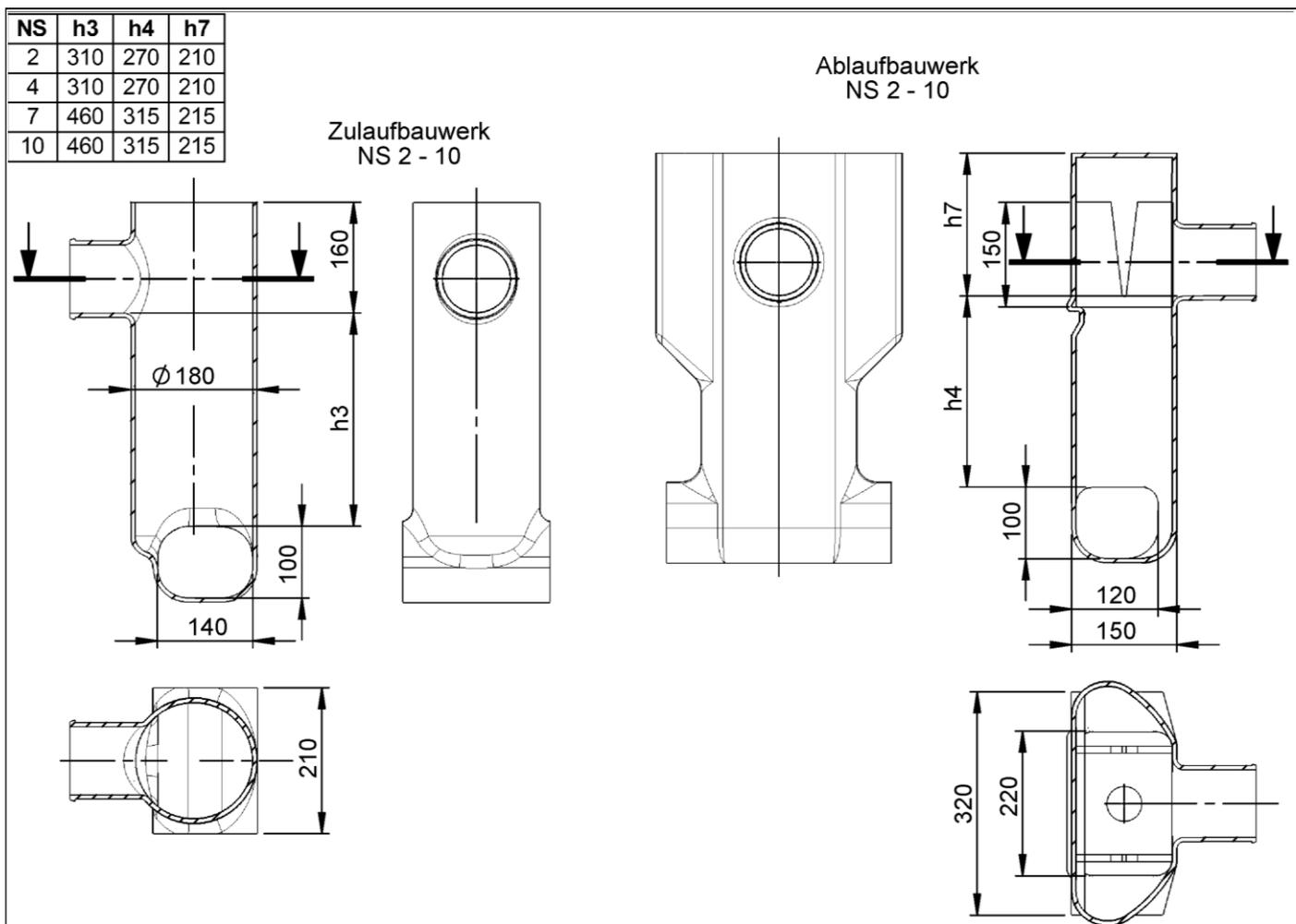
Abscheideranlage für Fette aus Kunststoff bestehend aus einem Abscheider und einem integrierten Schlammfang
