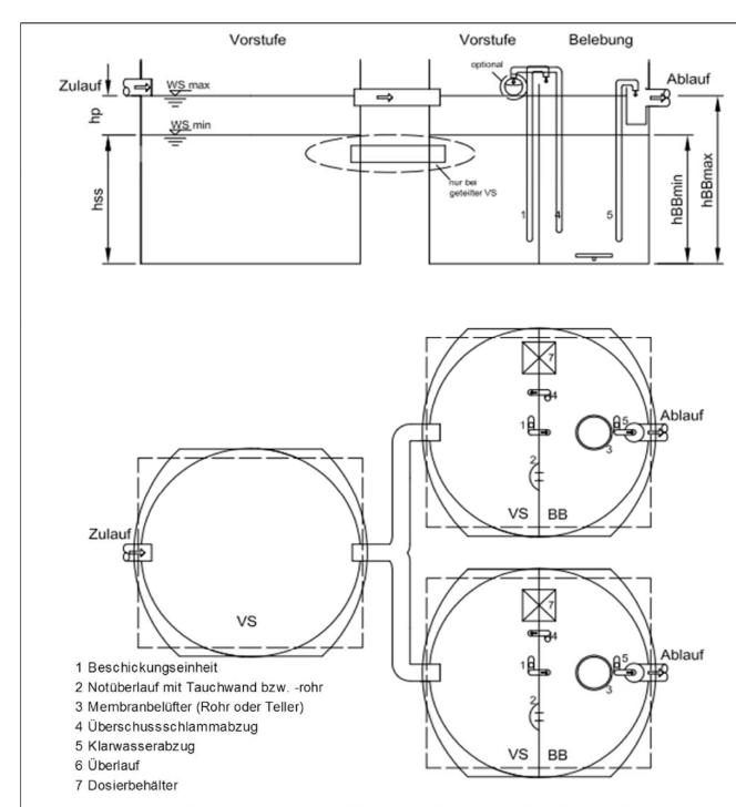
Alle Kammern können separate, in unterschiedlicher Form/Größe ausgebildete Behälter sein.
