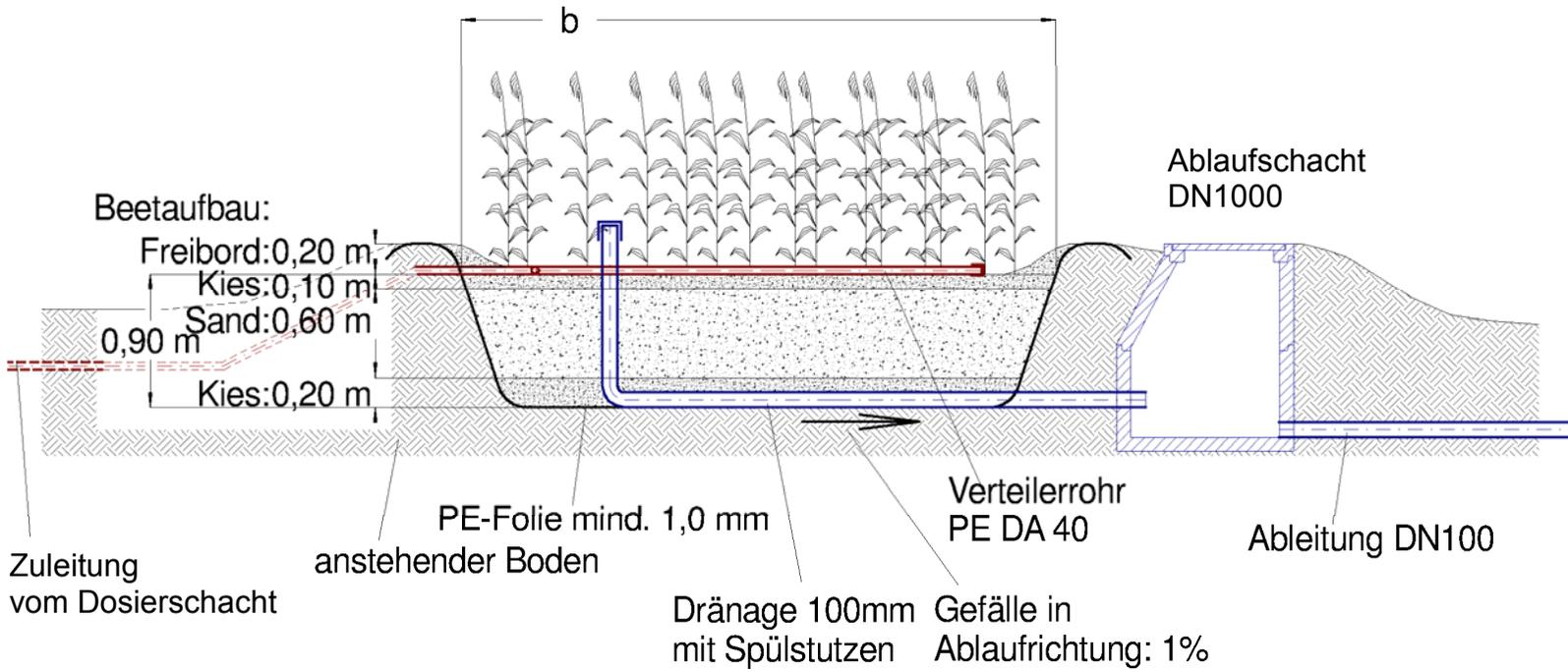
Kleinkläranlagen: bepflanzte Bodenfilter (Pflanzenbeete) nach Mehrkammergruben
