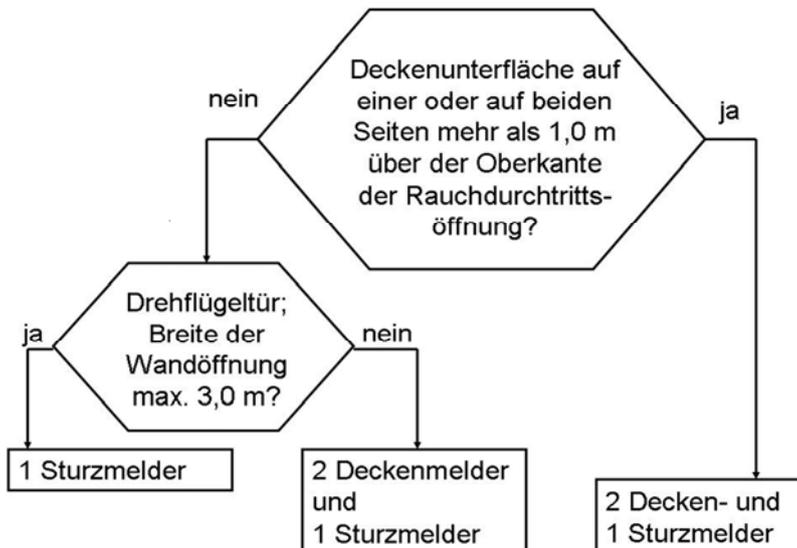
Bild 3: Entscheidungsdiagramm
