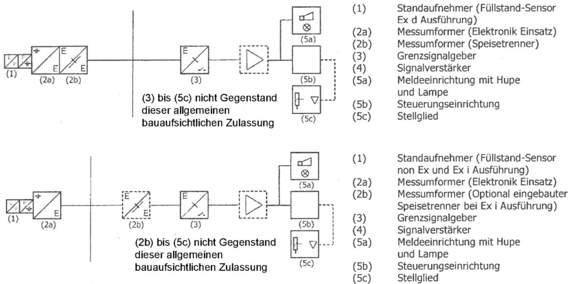
Standaufnehmer (Radar-Sensor) Typ "OPTIWAVE 5200" mit Messumformer als Teil von Überfüllsicherungen
