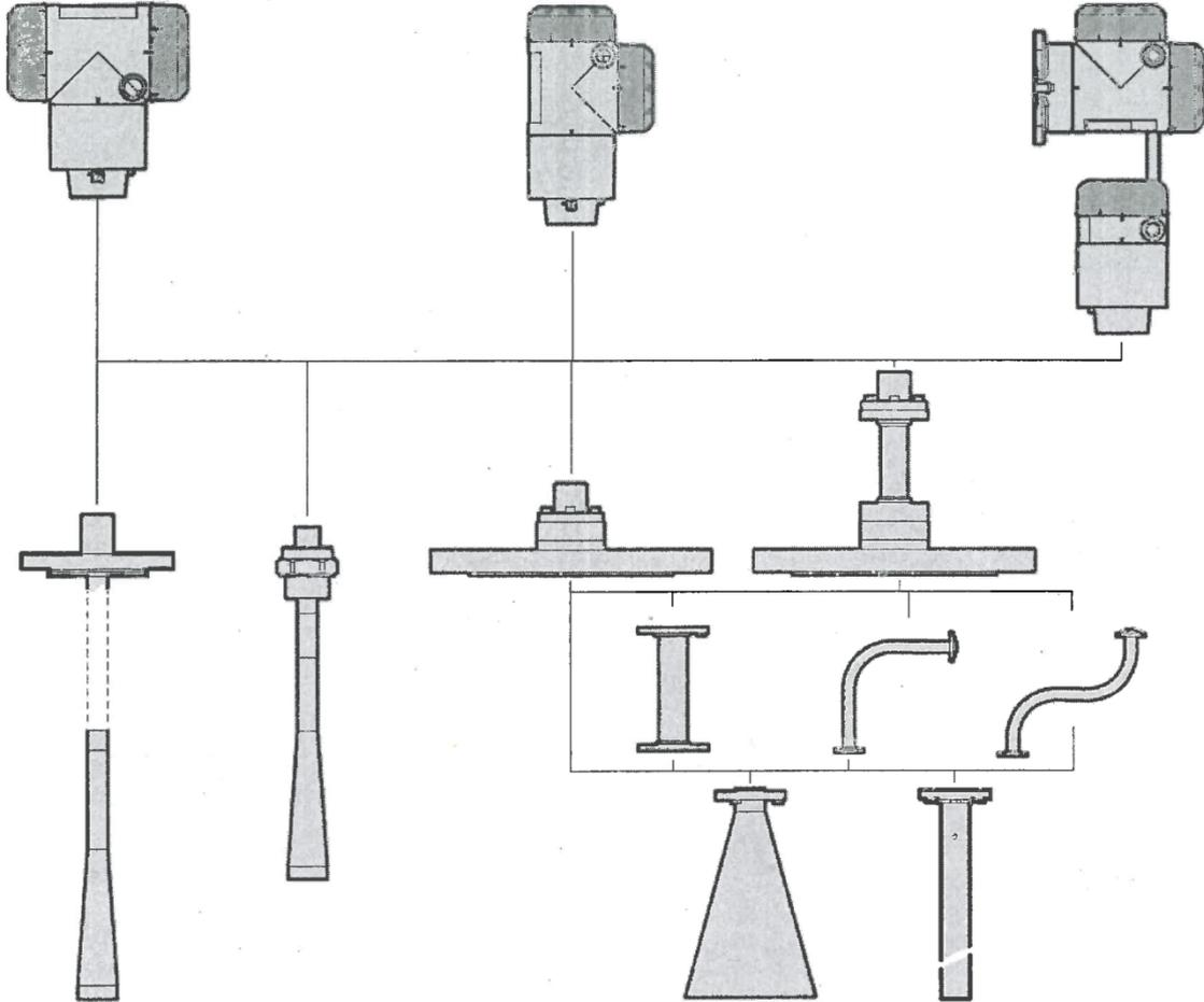
Schema der Überfüllsicherungen
