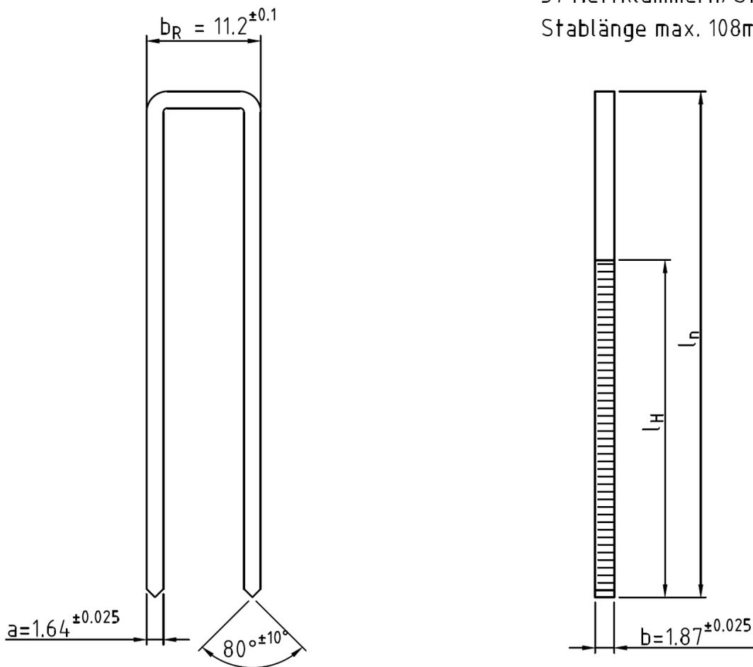
Rohstahl: Stahldraht  $\phi 1.80 \pm 0.01$  aus Werkstoff 1.0413/1.0414 (D 15-2/ D20-2) nach DIN EN 10016-2 mit einer Mindestfestigkeit von  $900 \text{ N/mm}^2$
