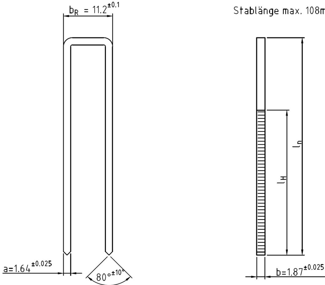
Rohstahl: Stahldraht  $\phi 1.80 \pm 0.01$  aus Werkstoff 1.0413/1.0414 (D 15-2/ D20-2) nach DIN EN 10016-2 mit einer Mindestfestigkeit von  $900 \text{ N/mm}^2$
