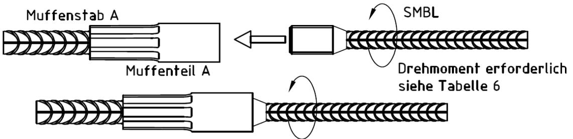
**Bild 3: Reduzierverbindung**
