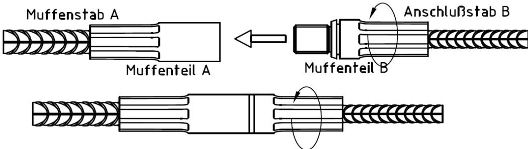
**Bild 4: Positionsverbindung mit Kontermutter**
