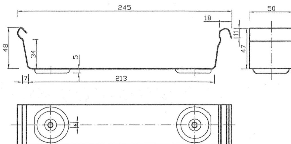
RIB-ROOF-Gleit-Falz-Profildach aus Stahl
