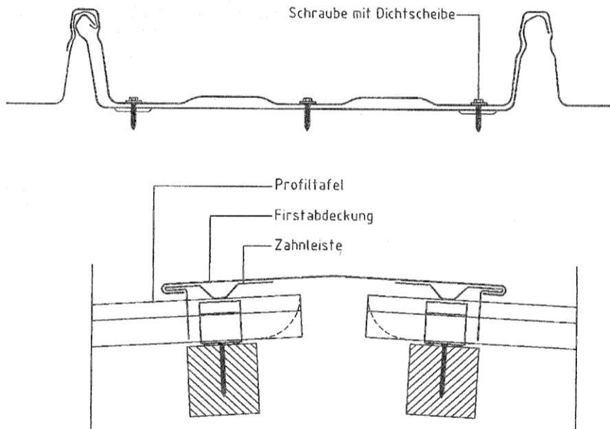
RIB-ROOF-Gleit-Falz-Profildach aus Stahl
