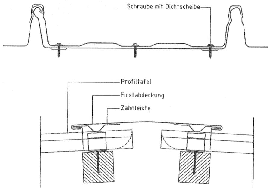
RIB-ROOF-Gleit-Falz-Profildach aus Aluminium
