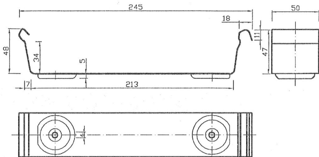
RIB-ROOF-Gleit-Falz-Profildach aus Aluminium
