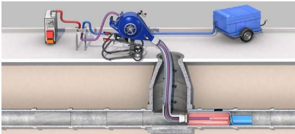
4. Kalibrierschlauch in den Schlauchliner invertieren. Für Zirkulation den Heizschlauch mit invertieren, andernfalls das Dampfauslassventil an den Kalibrierschlauchkopf einbinden.
