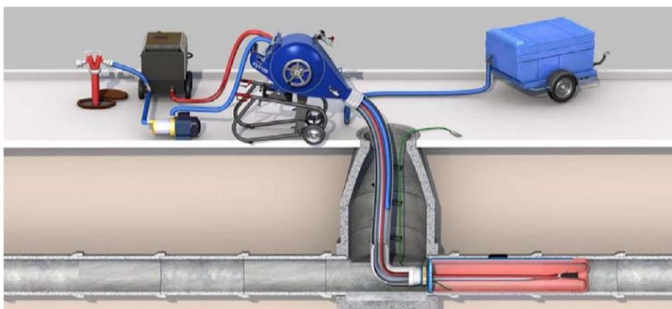
3. Aushärtung mit Kalibrierschlauch, heißes Medium wird zum Schlauchlinierkopf geführt und strömt im Schlauchliner zurück.
