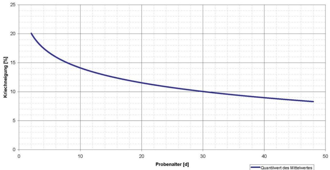
Die in der Prüfung an der auf der Baustelle entnommenen Probe ermittelte Kriechneigung darf in Abhängigkeit des Probenalters den Wert der Kriechneigung aus dem Diagramm 1 nicht überschreiten.
