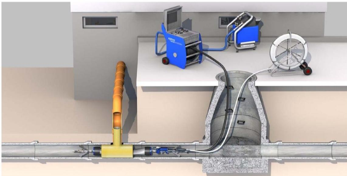
Ist der Aushärteprozess abgeschlossen, wird der Hebel „Pathfinder“ auf die Stellung „down“ gedreht. Den Hebel „Air/Vacuum“ auf „Vacuum“ drehen. Wenn der DrainLCR-S-Packer luftleer ist, kann dieser aus dem Rohr zurückgezogen werden.
