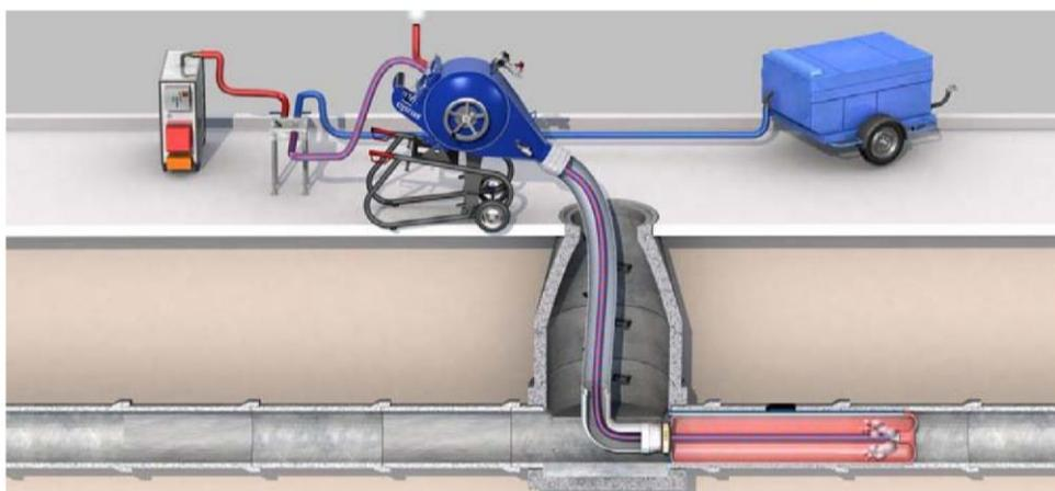
5. Aushärtung mit Kalibrierschlauch, heißes Medium wird zum Schlauchlinerkopf geführt und strömt im Schlauchliner zurück.
