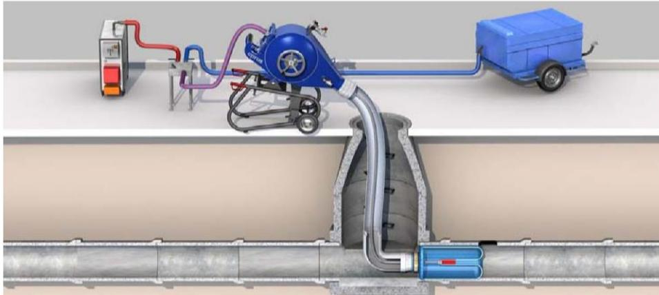
1. Schlauchliner mit eingeklebter LinerEndCap am Startpunkt positionieren.
