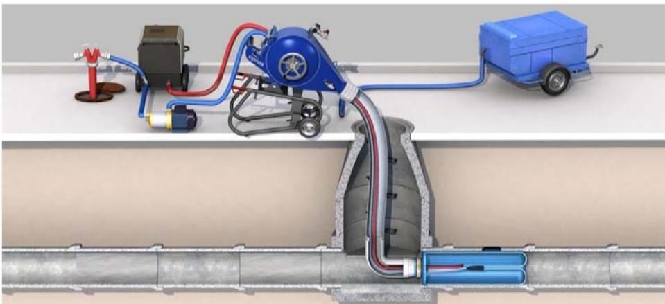
2. Inversion des Schlauchliners, Heizschlauch wird mit invertiert.
