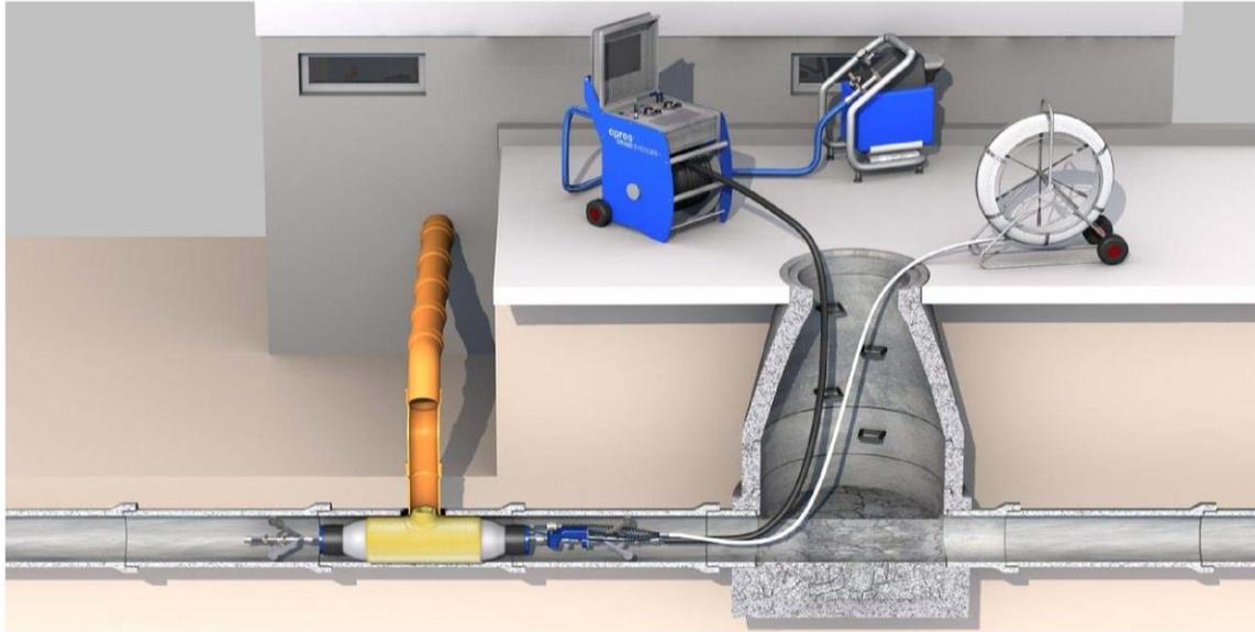
DrainLCR-Packer zurückziehen, bis sich der DrainLCR-Packerkorb in den Stutzen hinein schiebt und dadurch einrastet.
