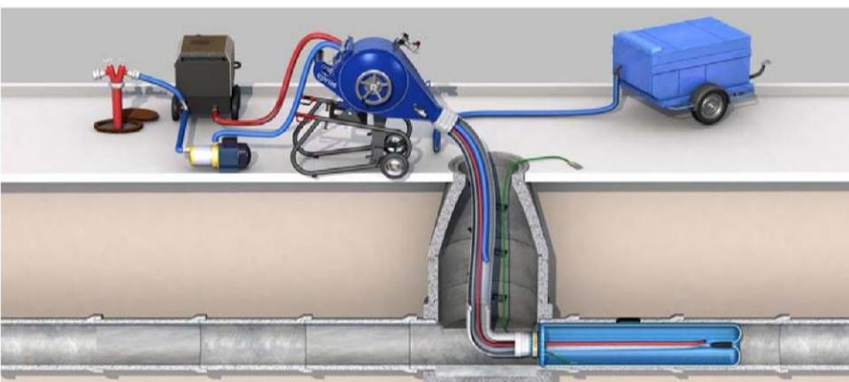
3. Warmwasseraushärtung: Medium wird zum Schlauchlinerkopf geführt und strömt im Schlauchliner zurück.
