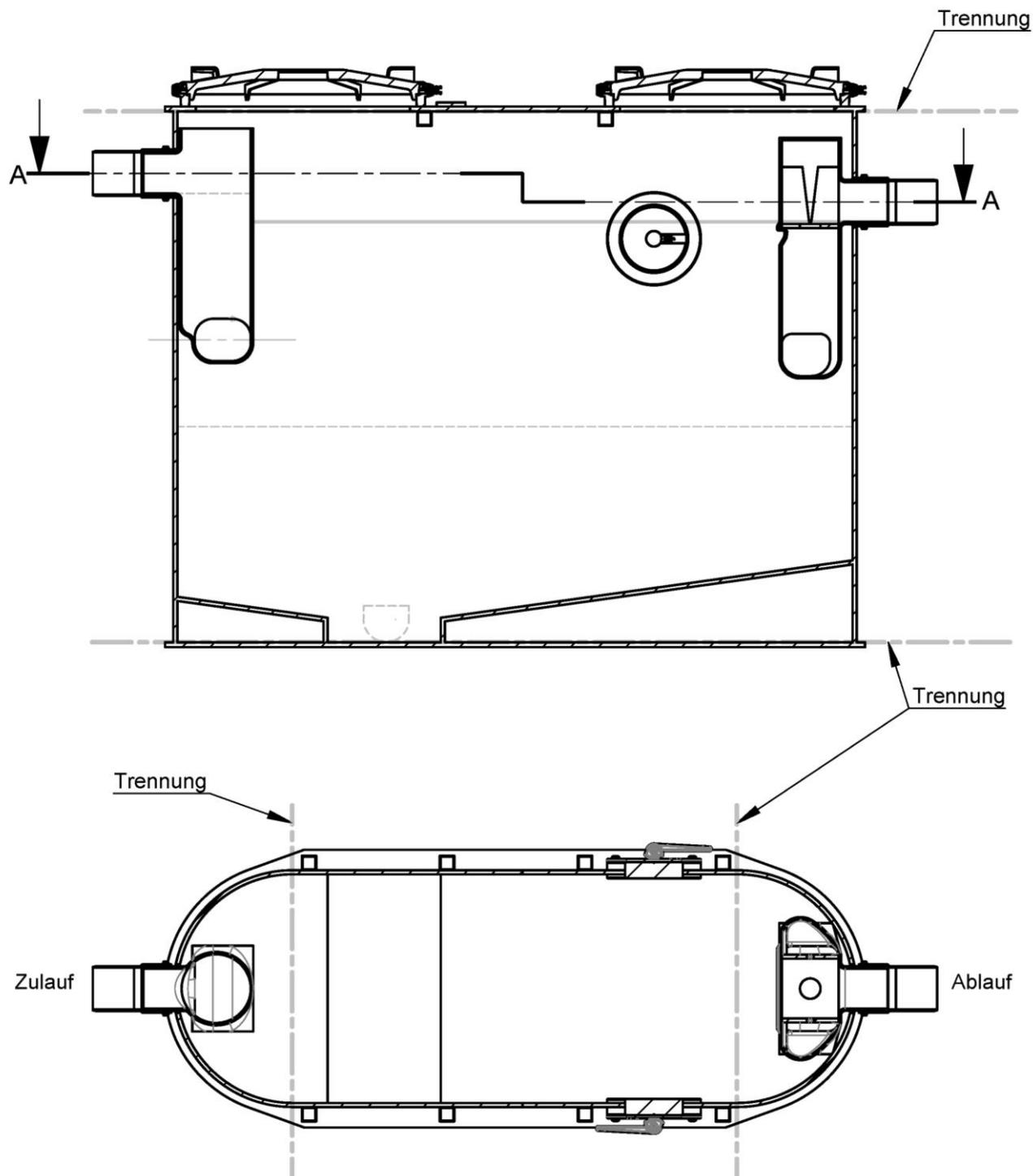
Abscheideranlage für Fette aus Kunststoff bestehend aus einem Abscheider und einem integrierten Schlammfang
