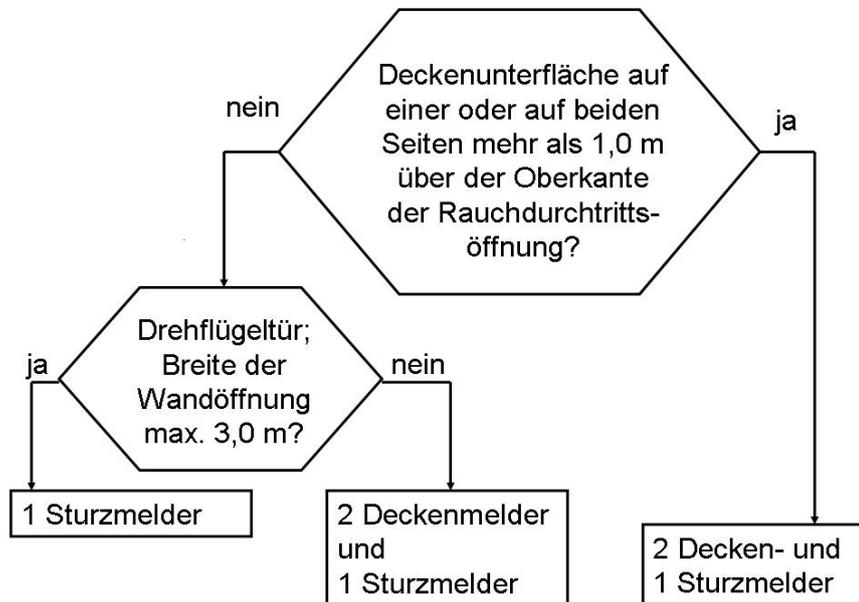
Bild 3: Entscheidungsdiagramm
