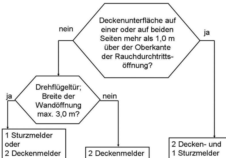
Bild 3: Entscheidungsdiagramm
